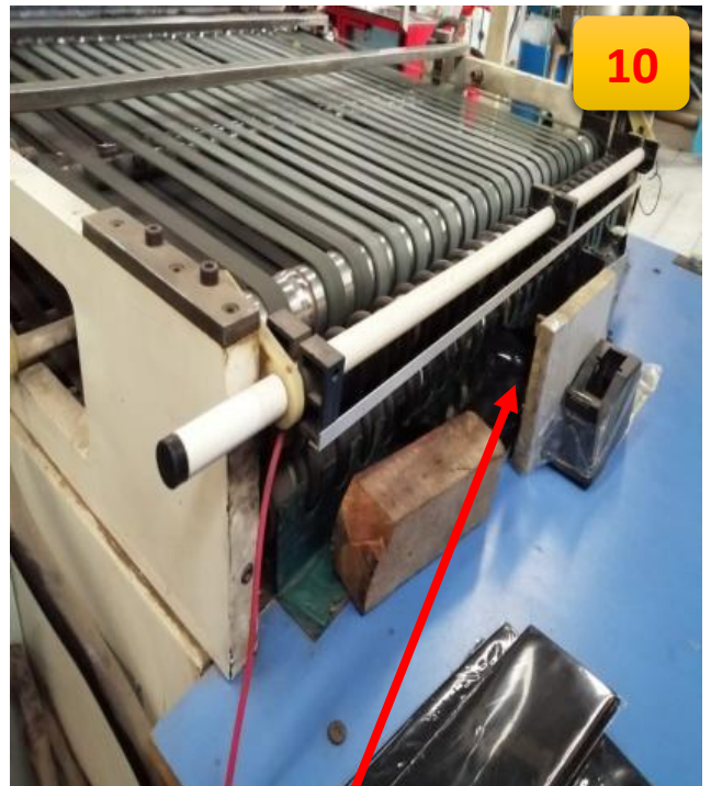
En esta imagen se aprecia como las bolsas ya caen cortadas del tamaño en que fueron configuradas y por ciento.
