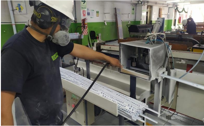
Figura 19. Sopleteado de reductor. Fuente: elaboración propia.
