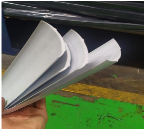
Figura 10. Zócalos. Fuente: elaboración propia.
