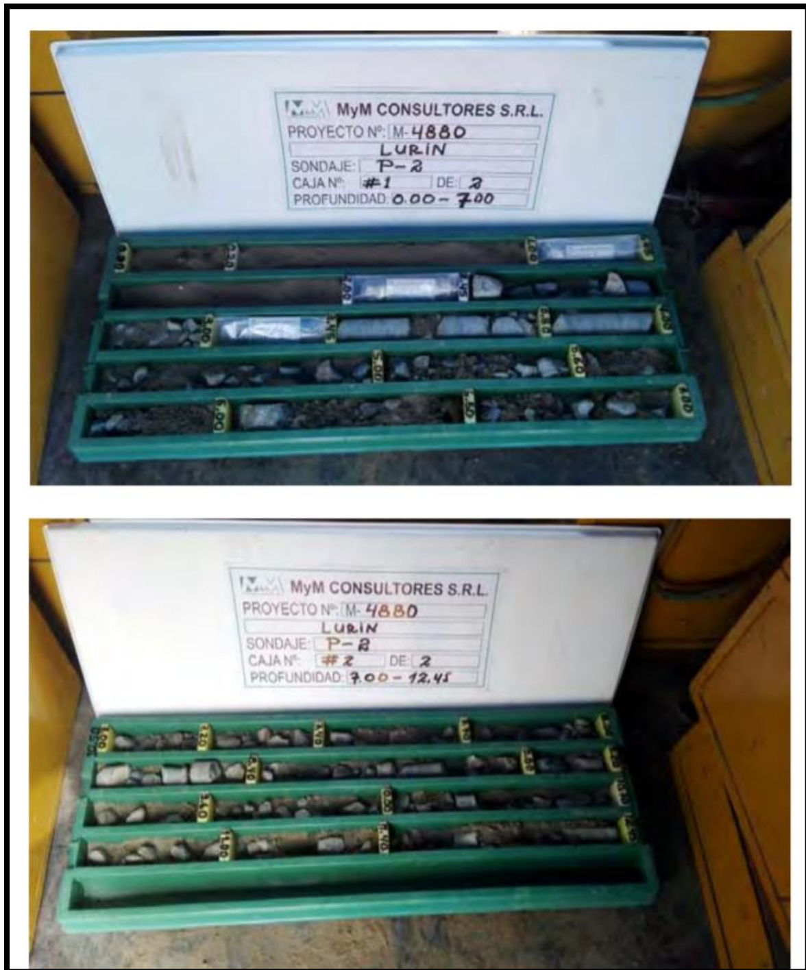
Figura 10: Cajas de muestras de la perforación rotativa P-2.
