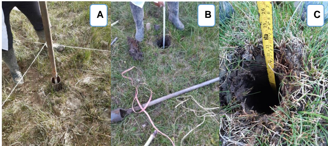
Figura 10. Proceso de medición de profundidad de turba
