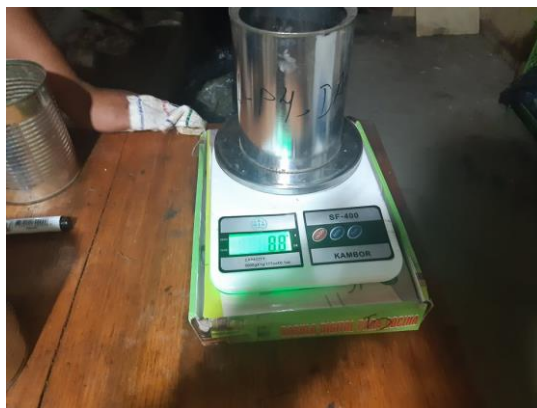
Figura 20. Peso seco de la densidad aparente
