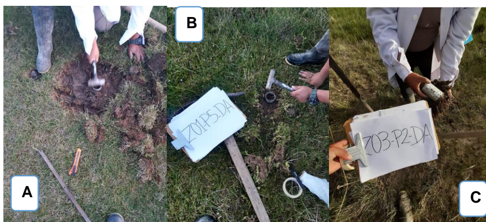
Figura 7. Proceso de extracción de muestras para medir la densidad aparente
