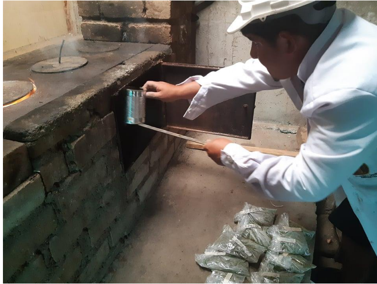
Figura 19. Proceso de secado de la densidad aparente y biomasa aerea.
