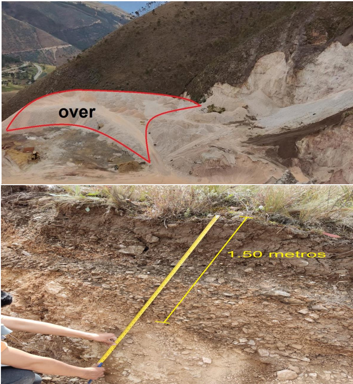
Ilustración 7. Over y Top Soil en cantera el Laurel.
