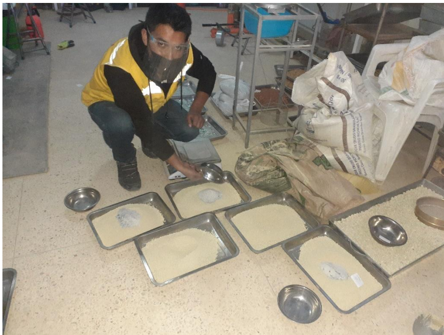
Fotografía 12: Incorporación de los porcentajes de vidrio de acuerdo a la gradación para ensayo Proctor modificado (4%, 7% y 10%).
