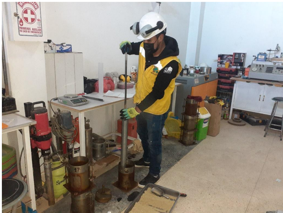
Fotografía 20: Compactación de la muestra en el molde del ensayo CBR.
