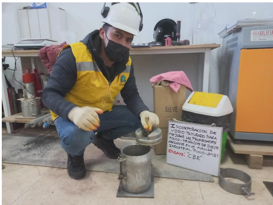
Fotografía 24: Colocación del papel filtro y el peso - ensayo CBR.
