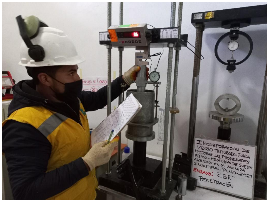
Fotografía 28: Aplicación de la carga y toma de lectura en la prensa CBR.
