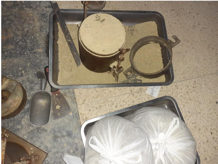
Fotografía 21: Enrasado del molde - ensayo CBR.
