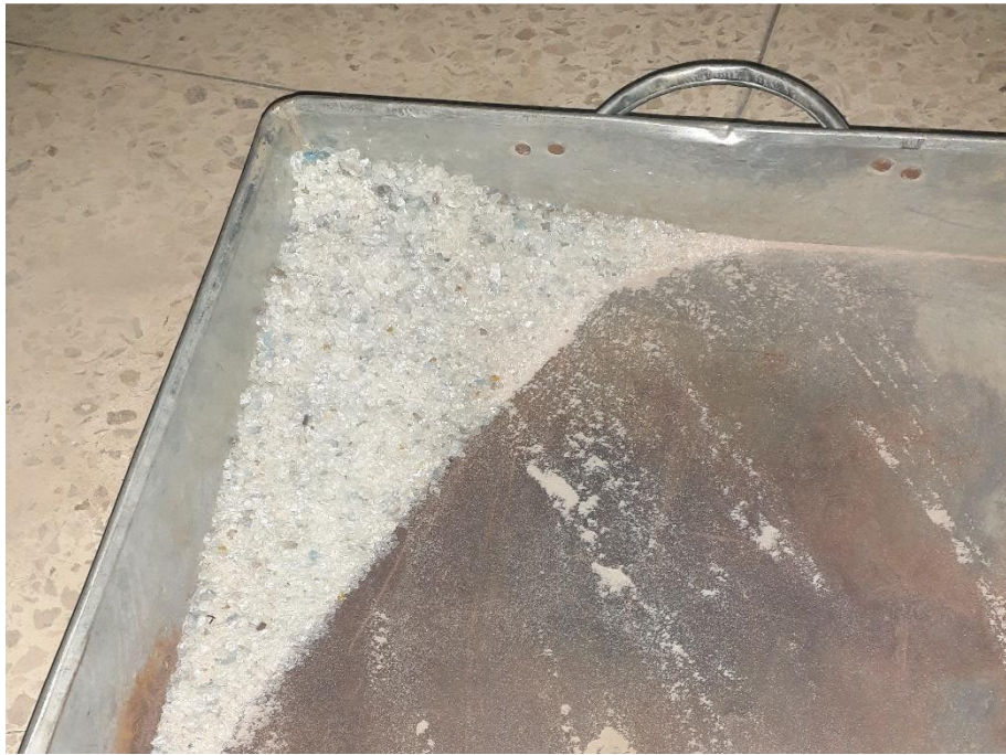
Fotografía 03: Obtención del vidrio triturado.
