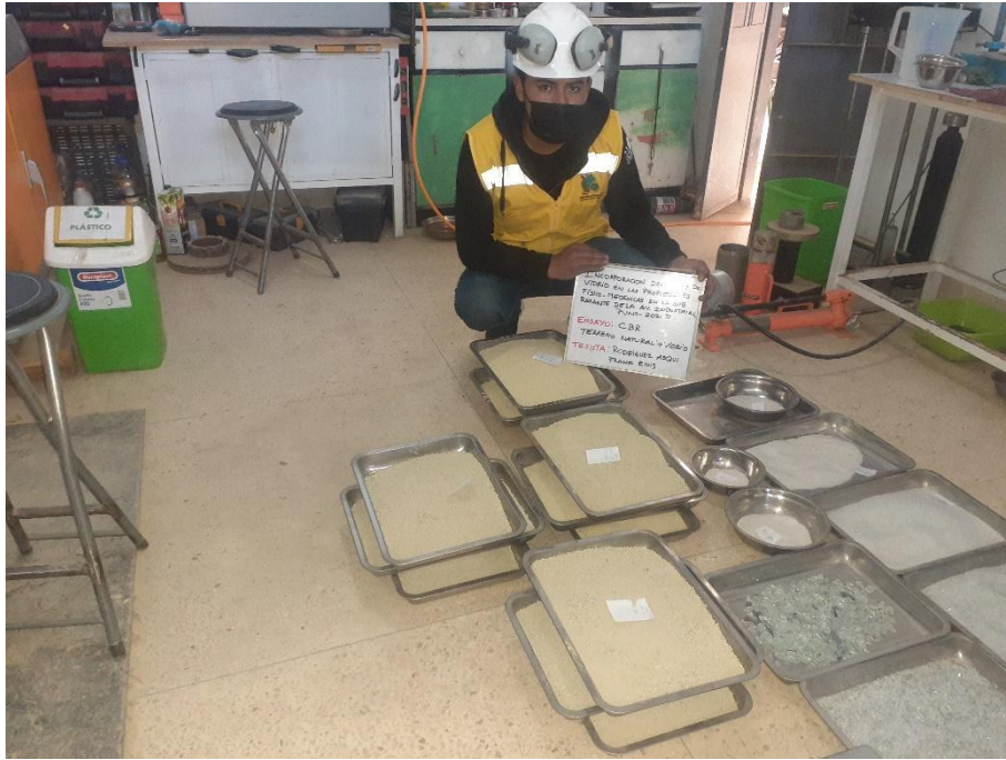
Fotografía 17: Incorporación de los porcentajes de vidrio de acuerdo a la gradación para ensayo CBR (4%, 7% y 10%).
