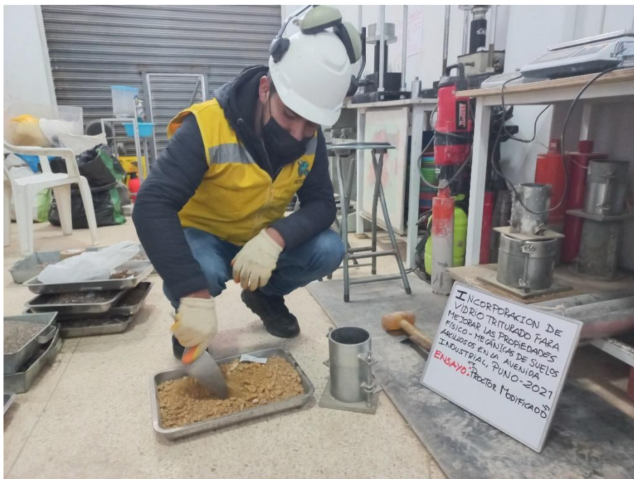
Fotografía 14: Llenado del molde del ensayo Proctor modificado.
