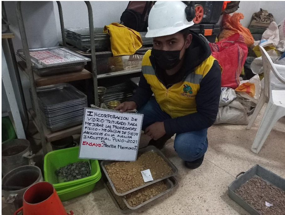
Fotografía 13: Preparación de las muestras con vidrio triturado incorporado para el ensayo Proctor modificado.
