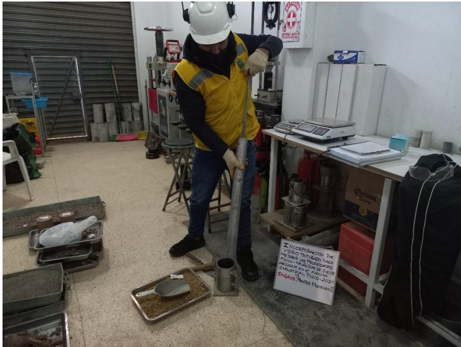
Fotografía 15: Compactación - ensayo Proctor modificado.
