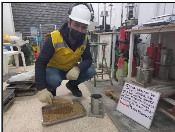
Figura 20. Ensayo Proctor modificado - llenado del molde.
