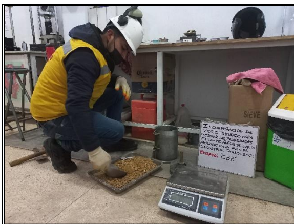
Figura 30. Llenado del molde CBR.
