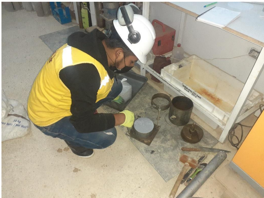
Fotografía 20: Colocación de la placa de soporte del ensayo CBR.
