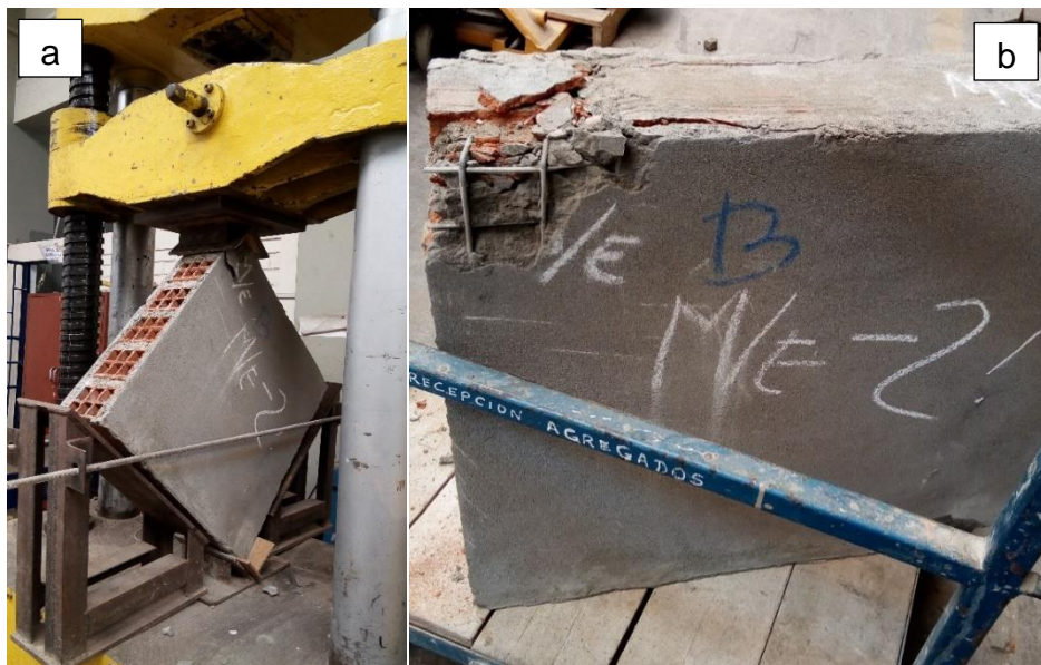
Figura 25. Ensayo de murete M/E-2 a compresión diagonal.
