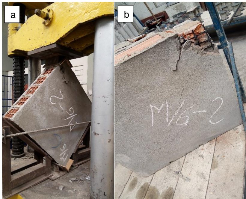
Figura 28. Ensayo de murete M/G-2 a compresión diagonal.
