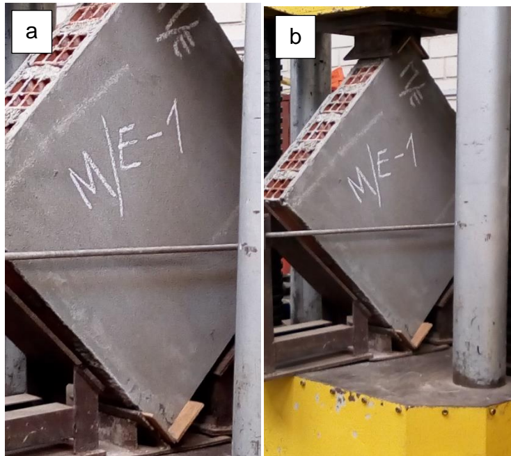
Figura 23. Proceso de montaje de muretes a máquina universal de ensayo.
