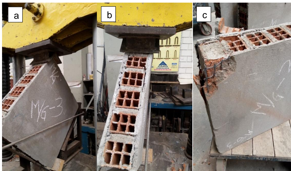
Figura 29. Proceso de ensayo de murete M/G-3 a compresión diagonal
