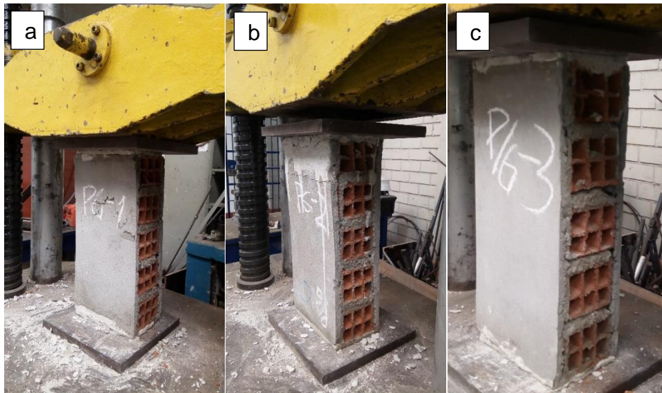
Figura 32. Ensayo de pilas P/G-1, P/G-2 y P/G-3 reforzadas con geomalla.
