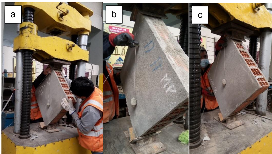
Figura 19. Proceso de montaje MP-1, MP-2 y MP-3, para el ensayo de muretes
