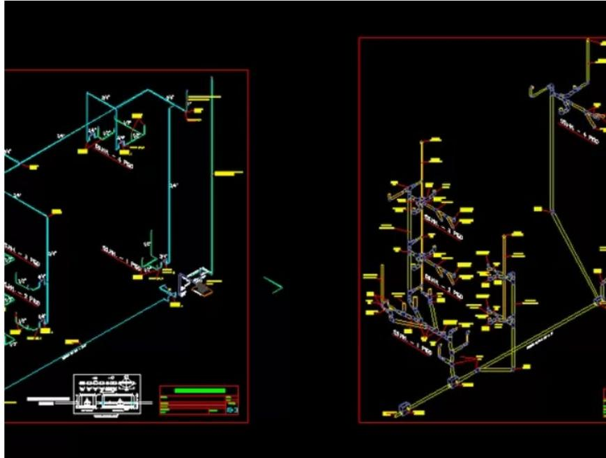
Figura 3. planimetría de agua y desagüé
