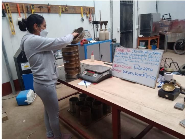
**Figura 28.** Elaboración del Ensayo Granulométricos del suelo.
