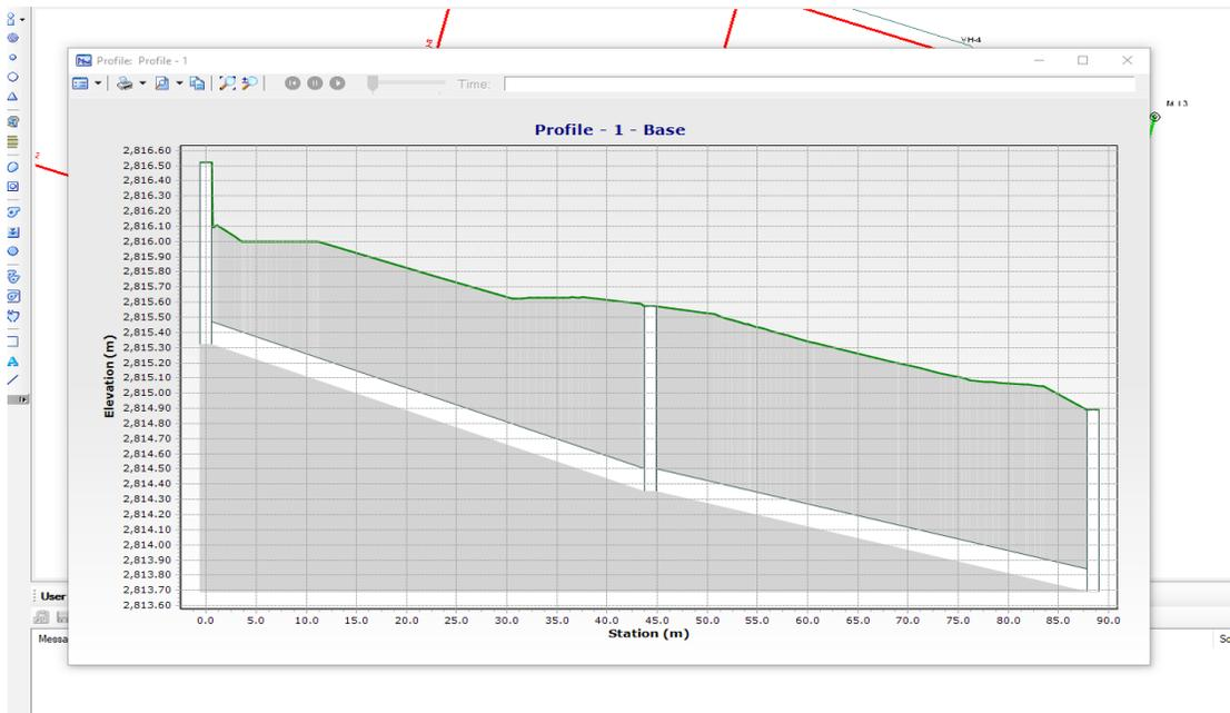
*Figura 66.* Perfil de red de alcantarillado con Elevación
