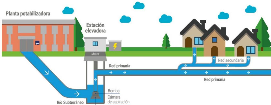
*Figura 8.* sistema de distribución de agua potable
