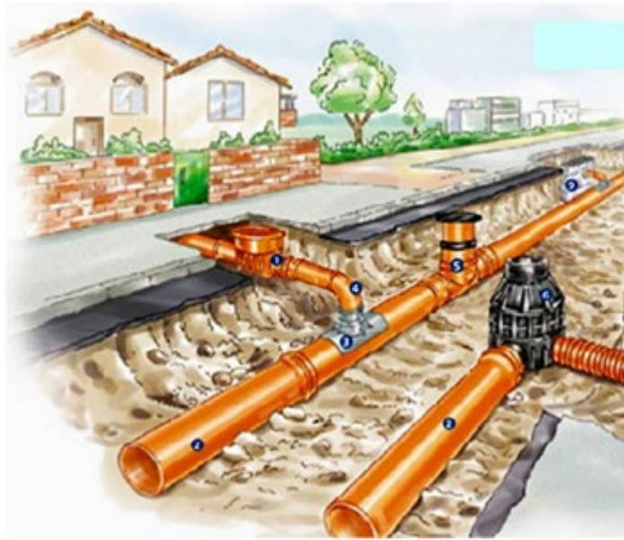
*Figura 17. Red de Alcantarillado*
