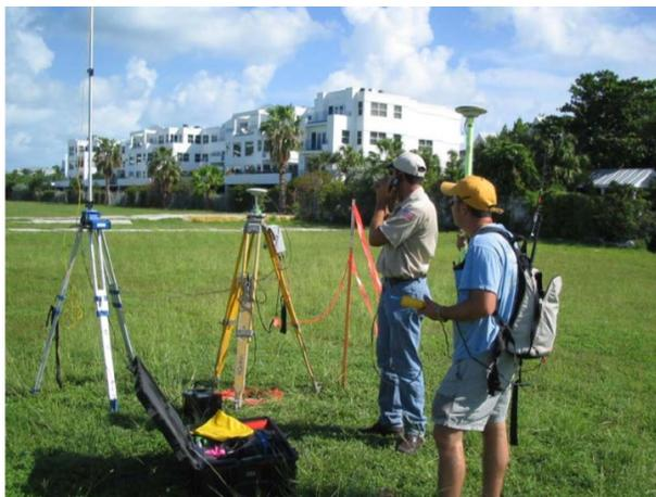
*Figura 2.* Estación base RTK y transmisor de enlace de radio, y rever con mochila
