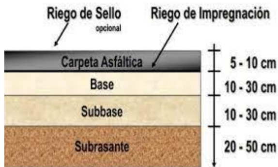
Figura 1: Estructura del pavimento
