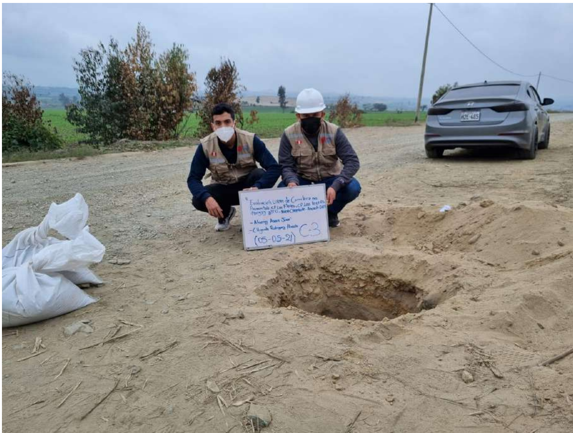
Imagen N° 22: Recolección de muestra de calicata N°3
