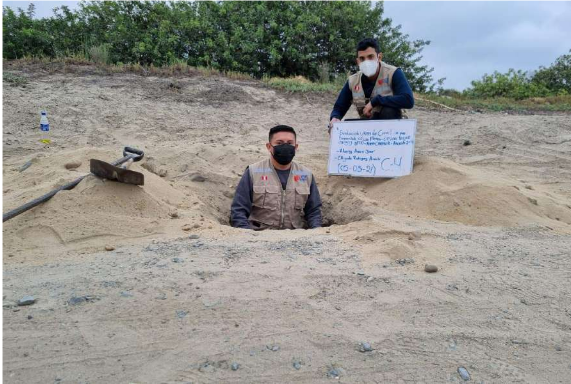
Imagen N° 23: Recolección de muestra de calicata N°4
