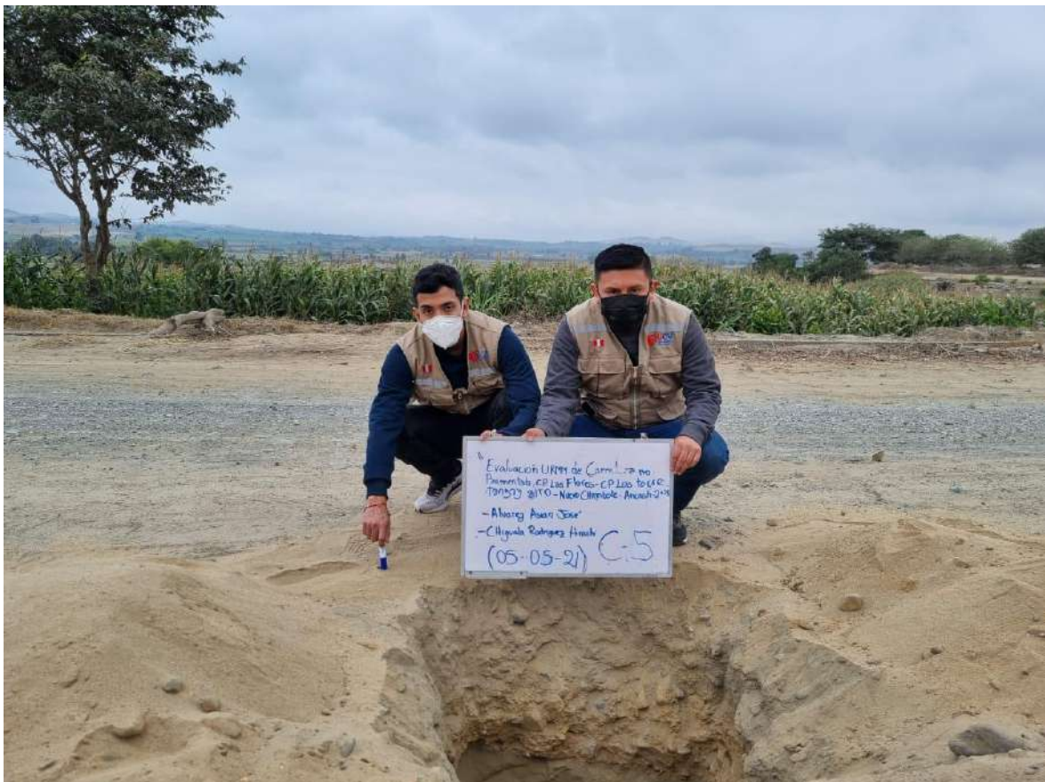
Imagen N° 24: Recolección de muestra de calicata N°5
