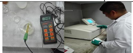
Reducción de pH de la muestra y lectura de la muestra en el espectrómetro UV
