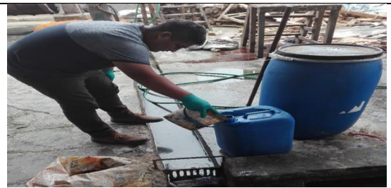
Toma de muestra de agua residual
