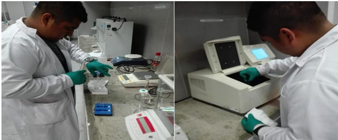
Figura 8. Utilización de espectrómetro - UV para determinar concentración de cromo.
