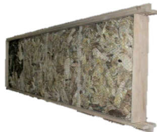
Panel con fibra de madera con malla de gallinero
