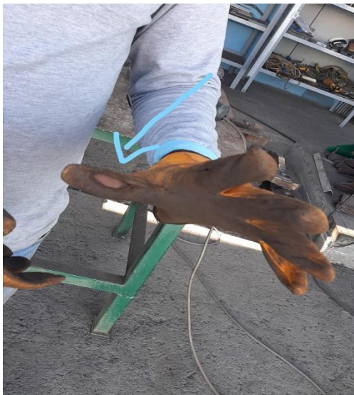
Figura 4: Se evidenció los guantes de seguridad desgastados
