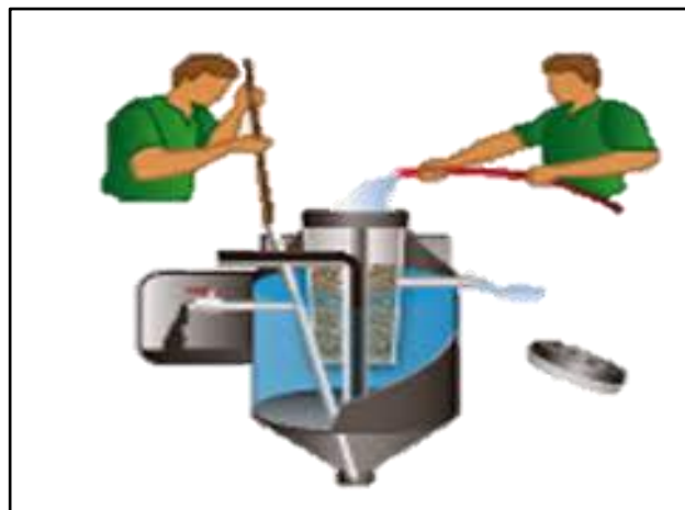
Figura 5. Limpieza de biofiltros del biodigestor.
