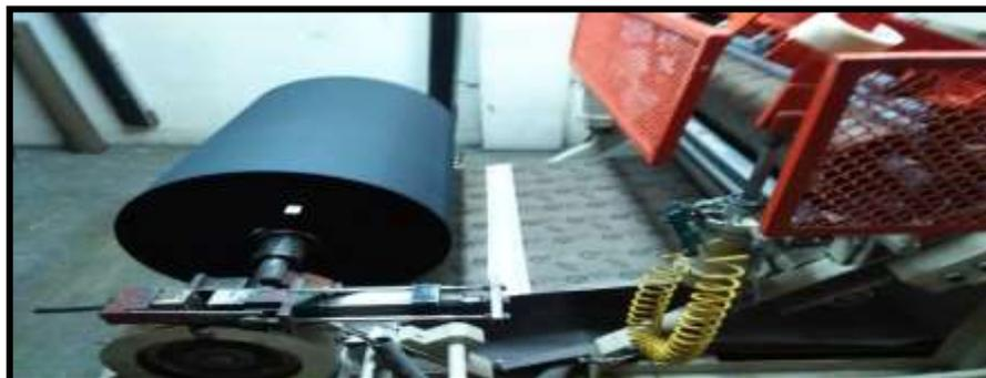
*Figura 37.* Empalme de rollo después de la mejora
