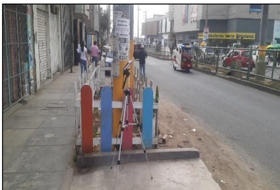
Foto N° 1: RA-01 Monitoreo de ruido ambiental en horario diurno
