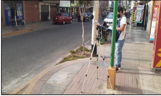
Foto N° 7: RA-04 Monitoreo de ruido ambiental en horario diurno
