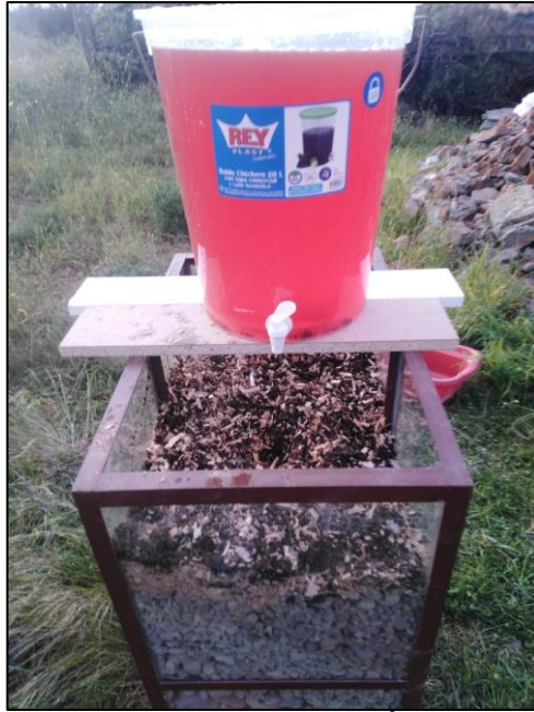
Figura 14 Sistema TOHÁ y Canal de Fitodepuración.
