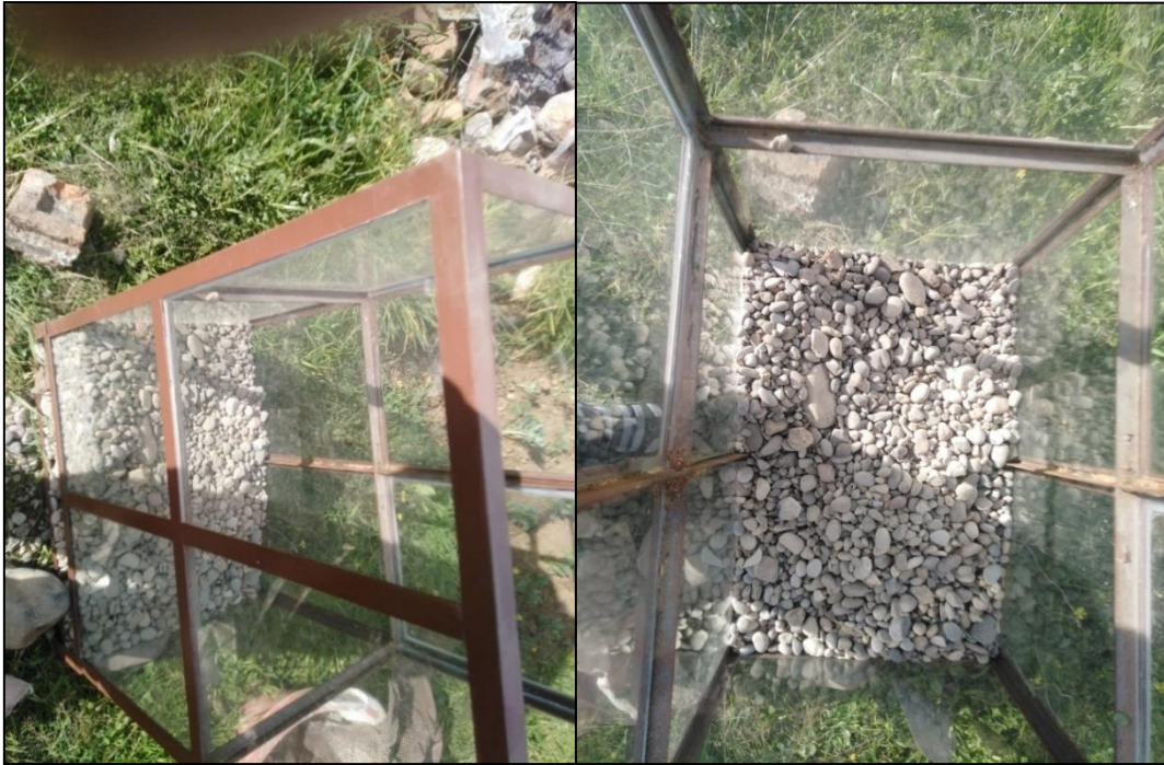
Figura 33 Piedra de río en sistema TOHÁ a una altura de 30 cm.
