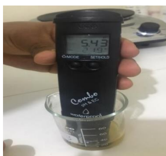
Figura 6: Medición de pH y temperatura del Aceite esencial de Citrus Paradisi
