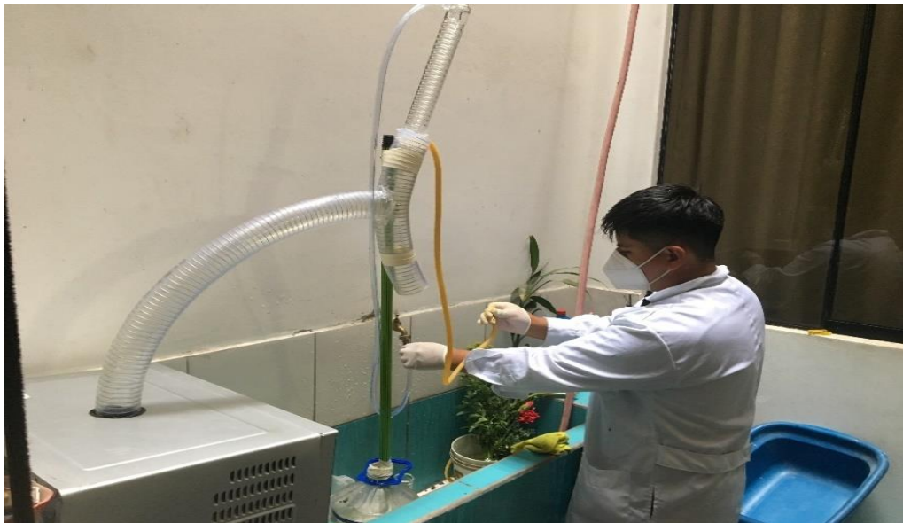
Imagen 2: Montaje y extracción de limoneno mediante la hidrodestilación asistida por microondas.
