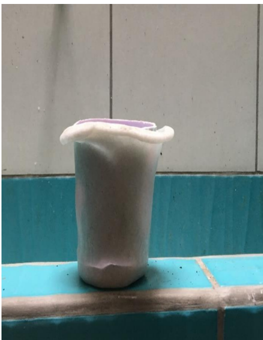
Imagen 7: Secado a temperatura ambiente después del prensado de poliestireno.
