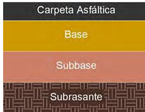
Figura 1. Pavimento Flexible Fuente: (Fiestas y Merino, 2020)
