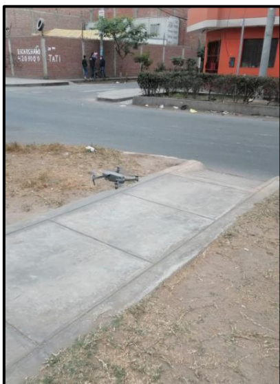
Figura 25. Dron para fotogrametría Fuente: Elaboración Propia
