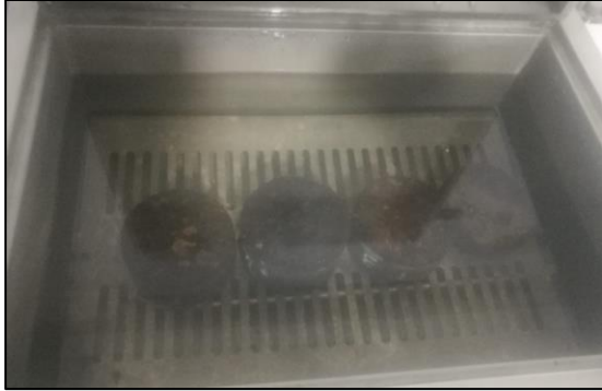
Figura 42. Testigos dentro del horno Fuente: elaboración propia
