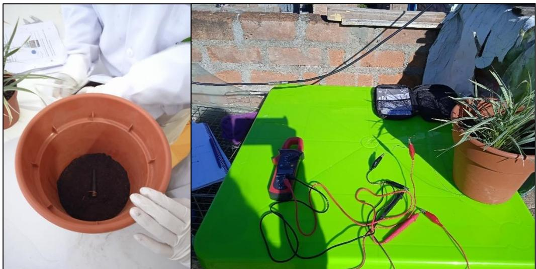
**Figura 6.** Montaje experimental del voltaje eléctrico generado en la pila de combustible microbiana de cinta
