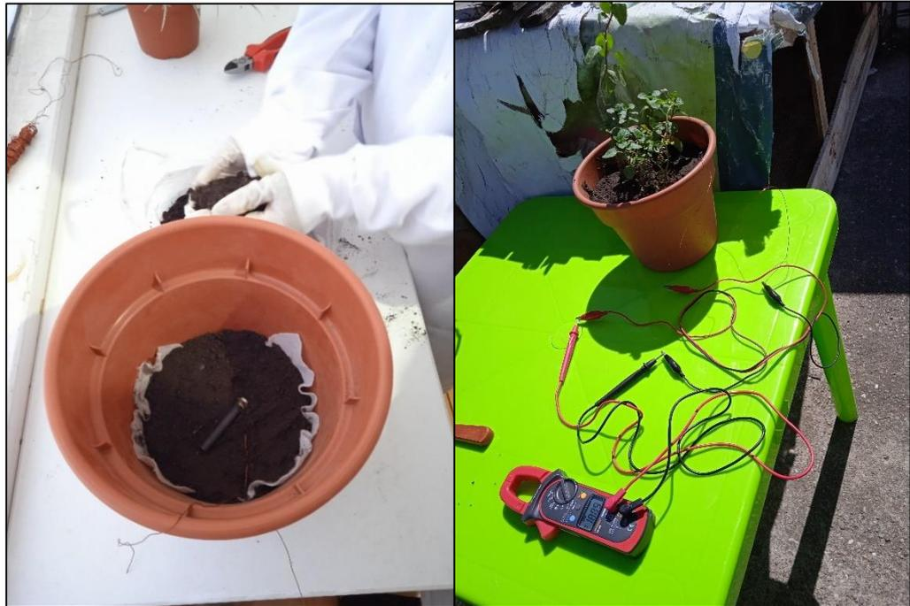
**Figura 5.** Montaje experimental del voltaje eléctrico generado en la pila de combustible microbiana de hierbabuena
