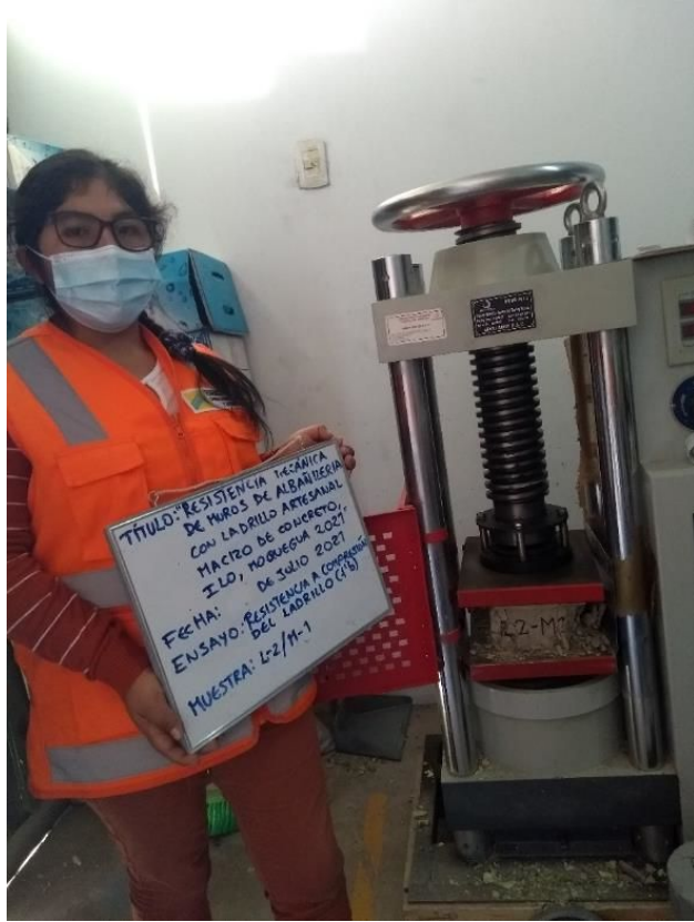
Fotografía N° 3: Ensayo de resistencia a compresión de la unidad de ladrillo artesanal de concreto macizo.
