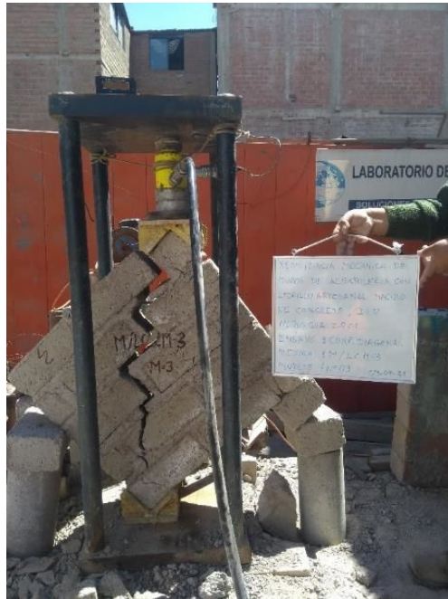
Fotografía N° 5: Ensayo de resistencia compresión diagonal de muro de albañilería con unidades de ladrillos artesanales de concreto macizo.
