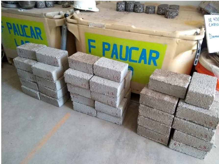
Fotografía N° 1: Muestras de unidades de ladrillos artesanales de concreto macizo, ladrilleras LCM-1, LCM-2 Y LCM-3.
