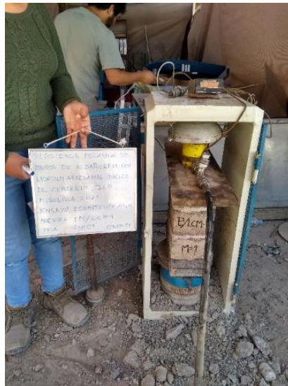
Fotografía N°4: Ensayo de resistencia a compresión axial de muro de albañilería con unidades de ladrillos artesanales de concreto macizo.
