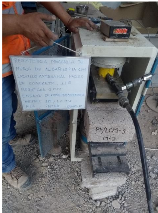
Fotografía 6: Ensayo de resistencia a flexión por adherencia de muro de albañilería con unidades de ladrillos artesanales de concreto macizo.
