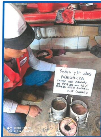
Foto N°19- Muestras de los moldes después del ensayo de CBR con incorporación del 12% del PCH.
