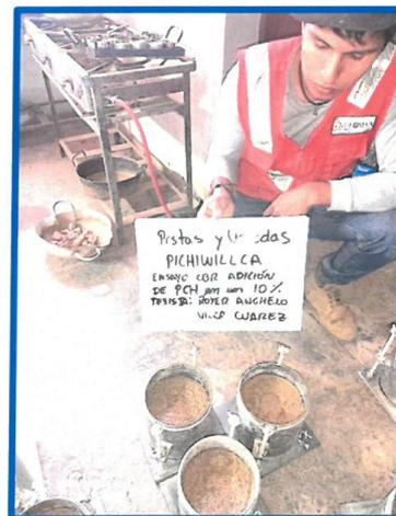
Foto N°18- Muestras de los moldes después del ensayo de CBR con incorporación del 10% del PCH
