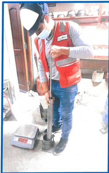
Foto N°10- Compactado de la muestra con el pistón para el ensayo de Proctor Modificado
