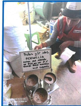
Foto N°17- Muestras de los moldes después del ensayo de CBR con incorporación del 5% del PCH
