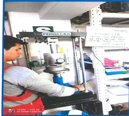
Foto N°14- Ensayo de CBR con incorporación del 10% del PCP
