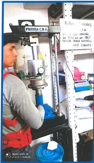
Foto N°16- Ensayo de CBR con incorporación del 15% del PCH
