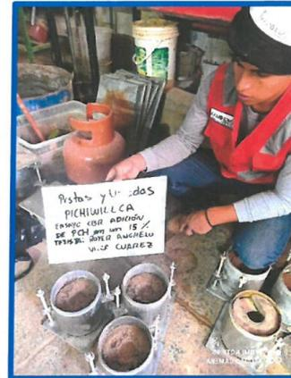
Foto N°20- Muestras de los moldes después del ensayo de CBR con incorporación del 15% del PCH.
