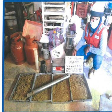
Foto N°11- Ensayo de Proctor Modificado en estado natural
