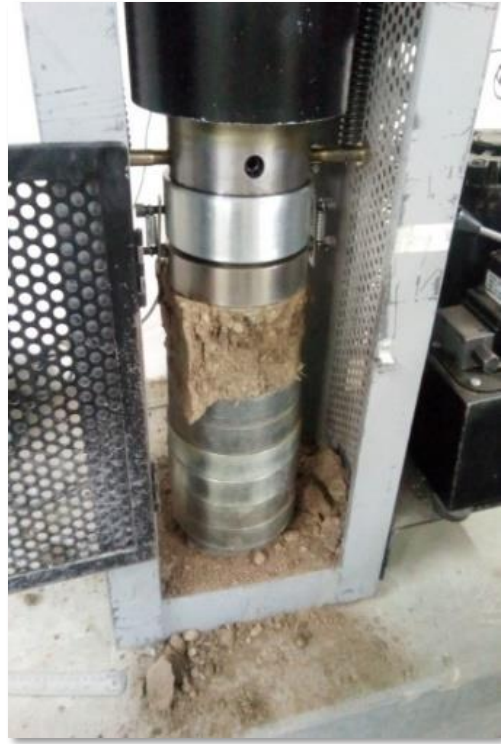
Adobe con adición de aserrín al 30% resistió una fuerza a compresión de 3157 kg
