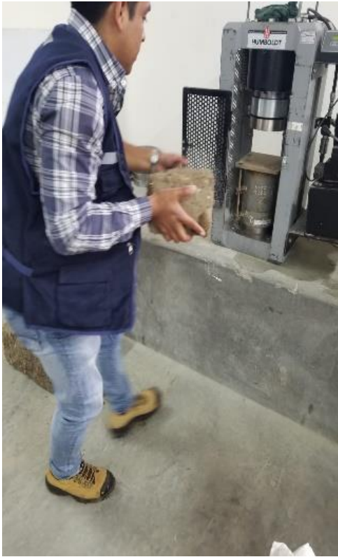
Adobe con adición de aserrín al 30% resistió una fuerza a compresión de 3157 kg
