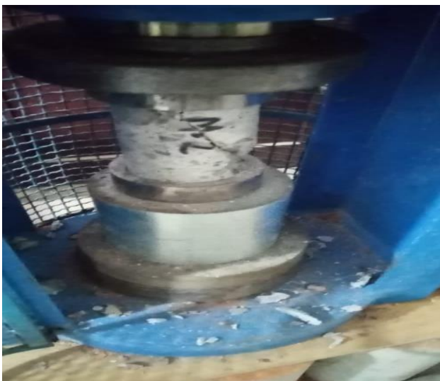
En las imágenes se puede apreciar rotura de las muestras extraídas en campo con equipo de diamantina de la av. Confraternidad Internacional Oeste Huaraz – Áncash – Perú.
