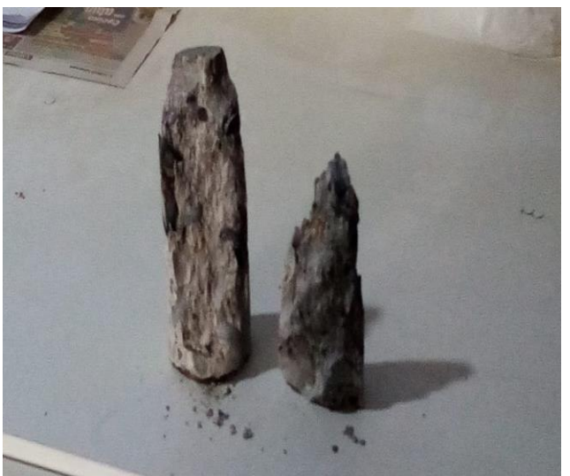
En las imágenes se puede apreciar rotura de las muestras extraídas en campo con equipo de diamantina de la av. Confraternidad Internacional Oeste Huaraz – Áncash – Perú.
