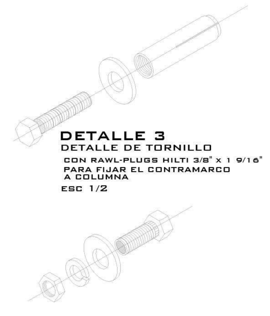
DETALLE 2 DETALLE DE TORNILLO CON ARANDELA PLANA Y ARANDELA DE PRESION CON TUERCA PARA FIJAR EL ANCLAJE EN LA PARED DE MAMPOSTERIA 3/8\"/>
