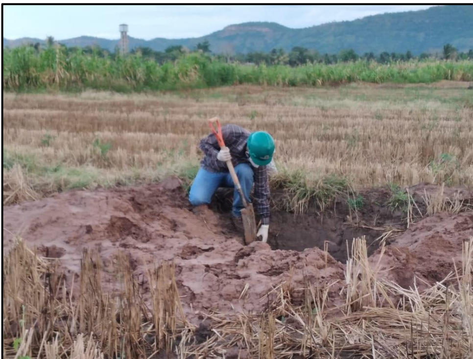
Foto 4: Extracción de suelo de una de las 9 calicatas ene estudio.
