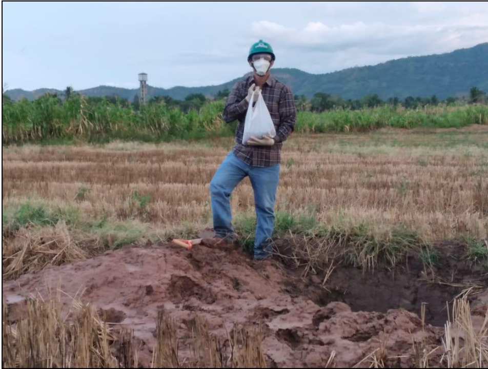
Foto 1: Extracción de 1000 gr de muestra de suelo.
