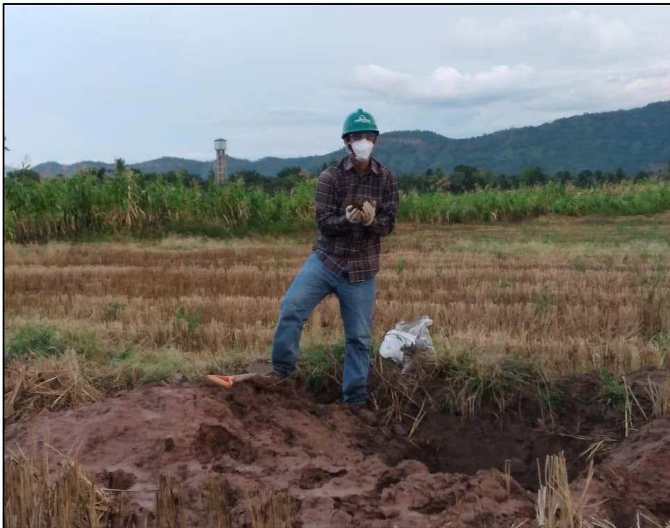
Foto 2: Preparación de la extracción de 1000 gr de muestra de suelo.
