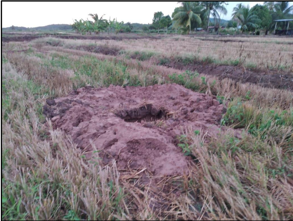
Foto 7: Preparación de la calicata.
