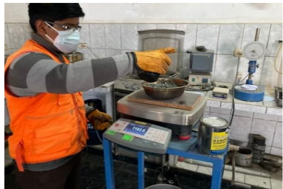
Fotografía 4. Pesar la muestra de agregado de la briqueta.
