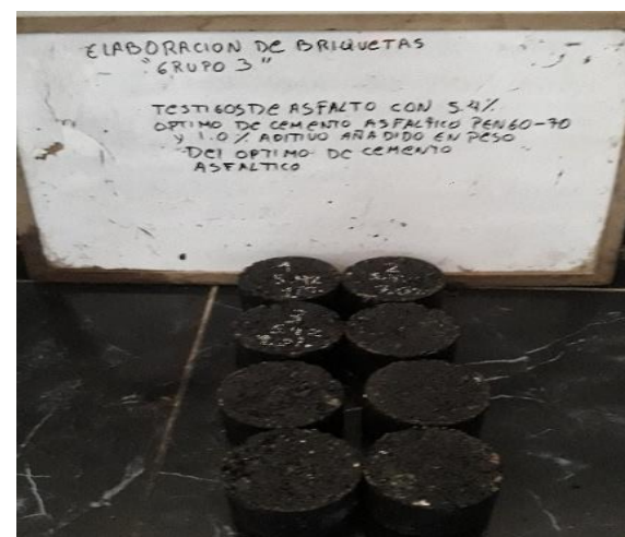
Fotografía 12. Grupo 2 briqueetas con 1.0% de aditivo y 5.4% óptimo de cemento asfáltico.
