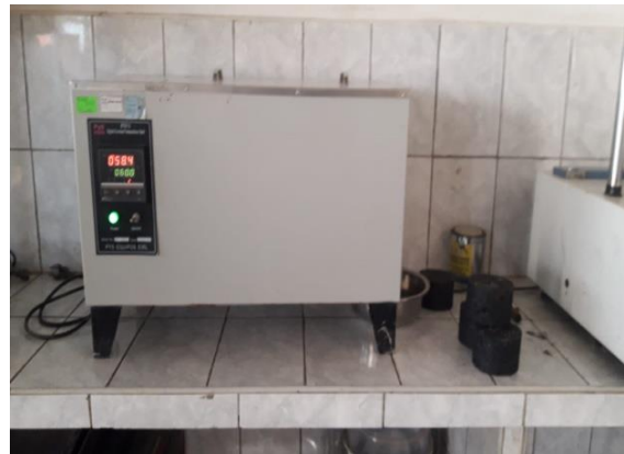
Fotografía 16. Equipo Baño María (ASTM D 1559) por 30 minutos a 60°C.
