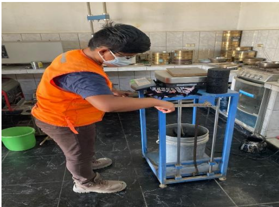
Fotografía 15. Peso sumergido. Al tener el peso al aire, peso húmedo semi seco y peso sumergido se procede al cálculo de las densidades.
