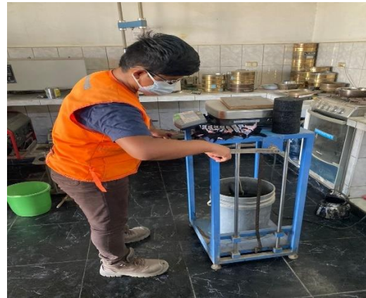
Figura 12. Peso sumergido de la briqueta.
