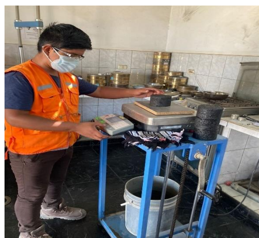
Figura 15. Determinación de los pesos para su posterior cálculo de vacíos
