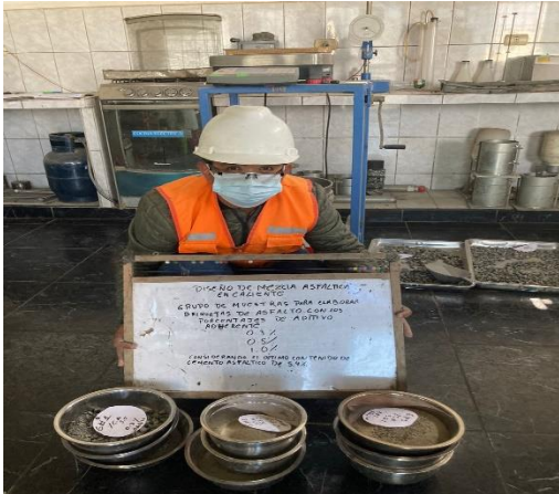
Figura 17. Muestras para la elaboración de briquetas con porcentajes de aditivo adherente para ensayo Marshall.
