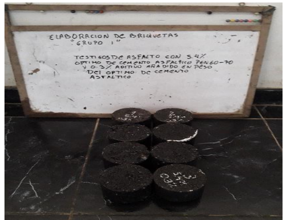
Fotografía 10. Grupo 1 briqueetas con 0.3% de aditivo y 5.4% óptimo de cemento asfáltico.
