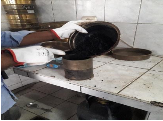
Fotografía 7. Colocación del agregado aditivo do en el molde de la briqueeta.
