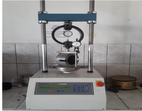
Figura 18. Cada grupo de briquetas con cada porcentaje dado, colocadas en la Equipo Prensa Marshall.
