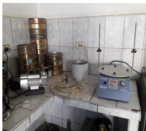
Figura 20. Equipo rice para someter a vacíos de aire 5- 10 minutos.
