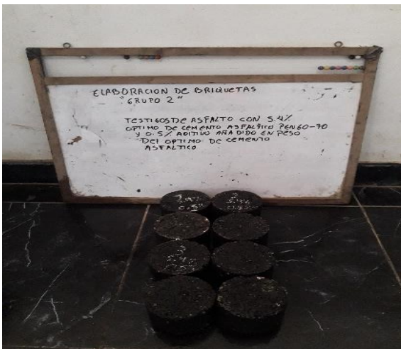
Fotografía 11. Grupo 2 briqueetas con 0.5% de aditivo y 5.4% óptimo de cemento asfáltico.
