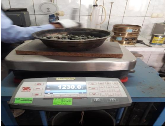
Fotografía 19. Peso para el moldeo de briquetas.
