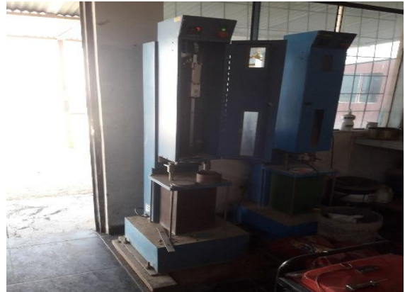
Fotografía 8. Máquina para proceder al golpe de las briqueetas.
