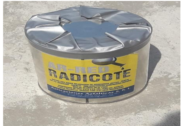
Fotografía 2. Al PEN agregar la muestra del aditivo (para el correspondiente pesaje) con cada porcentaje 0.3%, 0.5%, 1.0%.
