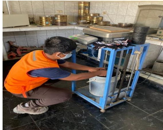
Fotografía 14. Peso húmedo semi seco se obtiene al introducir al agua temperatura del 25° por 5 minutos.
