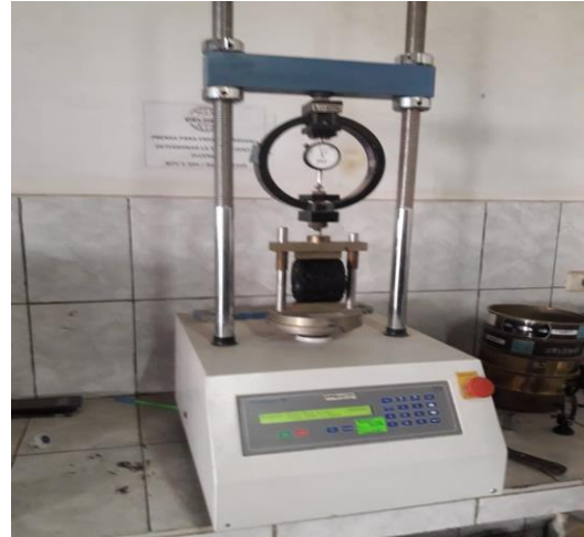
Figura 7. Evaluación de la briqueta para determinar para diseño patrón
