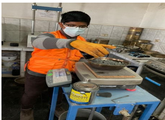
Fotografía 5. Pesar la muestra de los agregados para la elaboración de la briqueta incorporando el PEN aditiva do.
