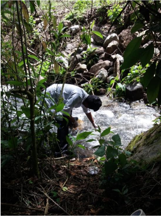
Fotografía N° 1 Toma de muestras del Punto 1 para parámetros Físicoquímicos, Microbiológicos, DBO, OD y Methomyl
