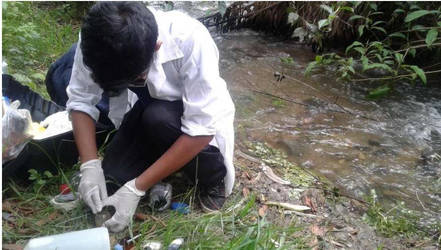
Fotografía N° 4 Se agregó químicos conservantes al recipiente para OD, Sulfato manganeso, Yoduro alcalo y Acido sulfurico
