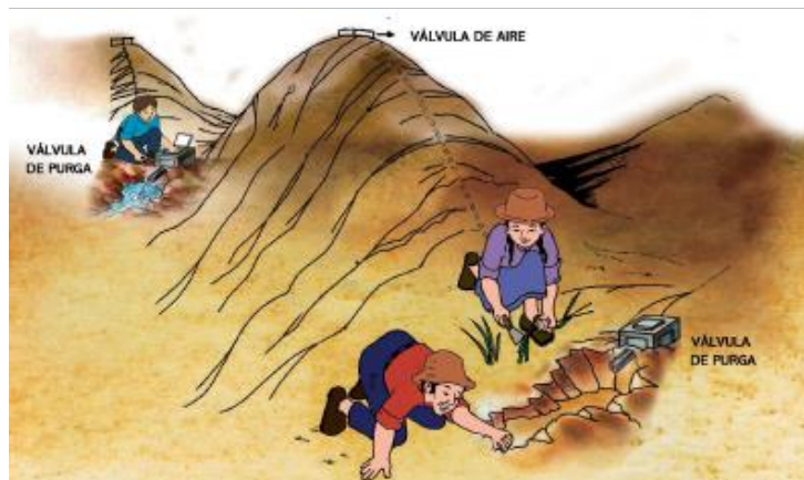
Figura 0.7 - Limpieza externa de cámaras
