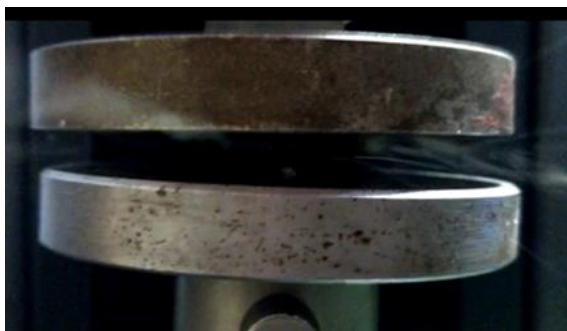
Fuerza de compresión a la resina entre la mordaza superior que desciende con respecto a la mordaza inferior, hasta generar la fractura.
