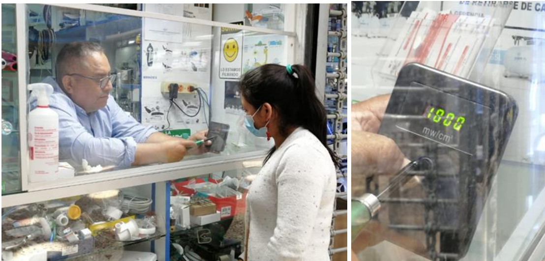
Foto 8: Calibración de la intensidad de luz de la lámpara de fotocurado Led H con el radiómetro.
