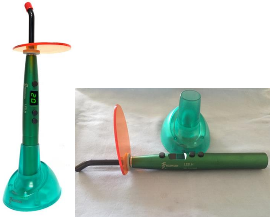
Foto 7: Lámpara de fotocurado modelo Led – H de la marca Woodpecker potencia 1000\text{mW}/\text{cm}^2 \sim 1200 \text{ mW}/\text{cm}^2 .
