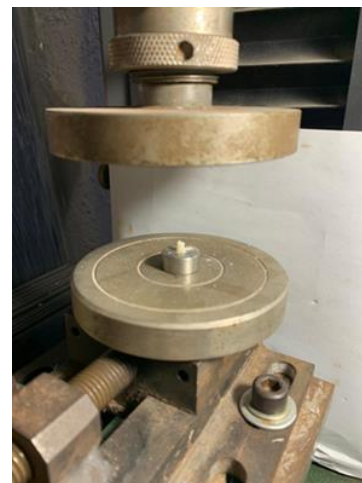
Fuerza de compresión a la resina entre la mordaza superior que desciende con respecto a la mordaza inferior, hasta generar la fractura.
