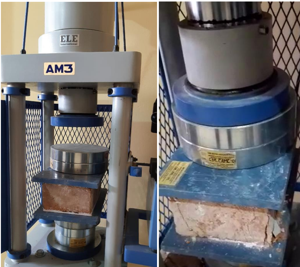
Figura 17: Ensayo resistencia a la compresión de las unidades
