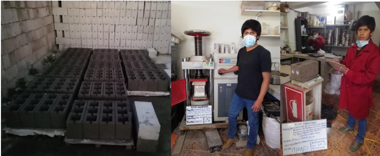
Figura 10. Preparación de moldes, Ensayo de resistencia a compresión y pesado de la muestra superficialmente saturado.
