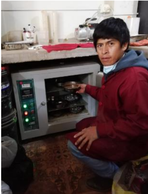
Secado de muestras al horno mínimo 24h a más de 100° C
