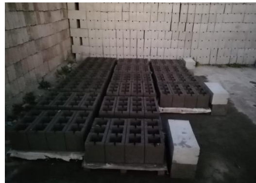
Muestra de bloques de concreto patrón y con puzolana al 5%, 10% y 15%.
