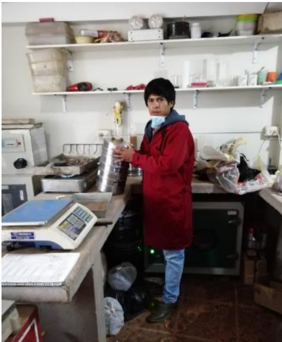
Tamizado de los agregados fino y grueso
