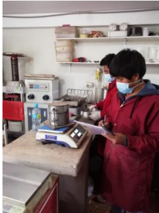
Peso unitario compactado de agregado fino
