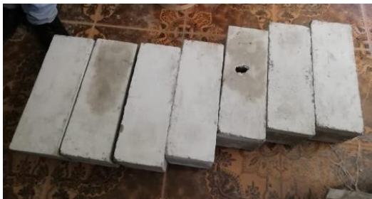
Refrentado de las unidades de albañilera antes del ensayo de resistencia a la compresión
