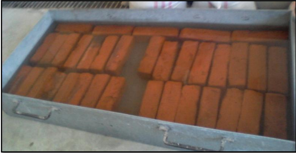
Figura N°4. Absorción de humedad de los ladrillos.
