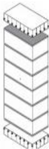
Figura N°5. Compresión uniaxial de una pila de alarifazgo
