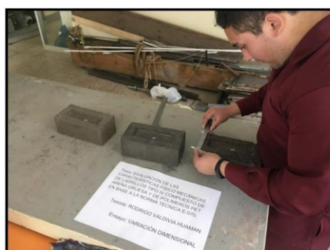
Figura N°11. Ensayo de Variación de Dimensiones
