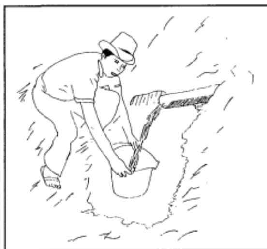
Figura 3.6 : Aforo del agua por el método volumétrico
