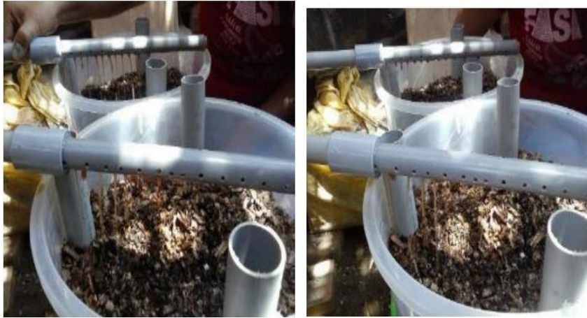
Vista de la alimentacion con agua residual a los dos biofiltros de lombrices
