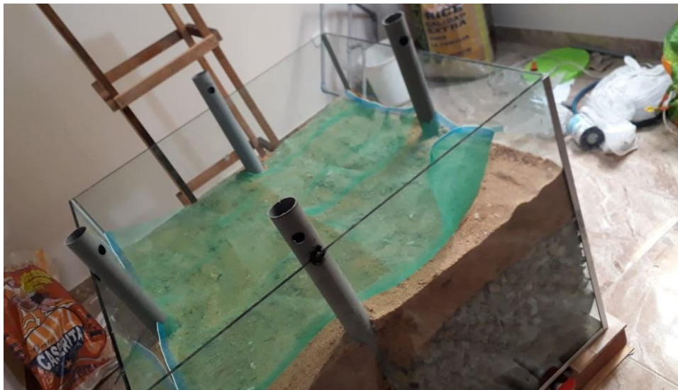
Imagen N° 04. Colocación de las capas del biofiltro, incluido la malla raschel.
