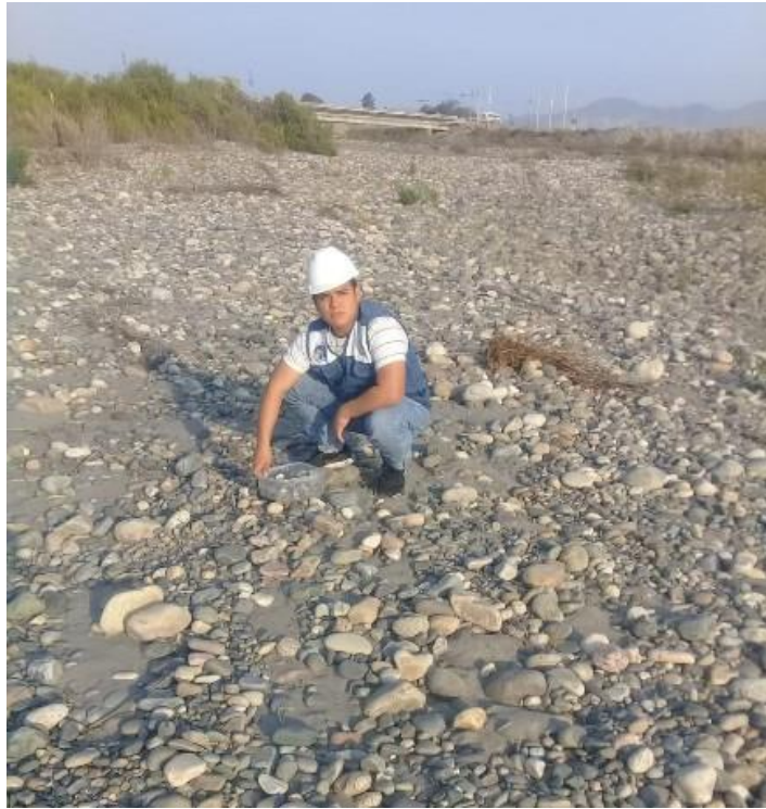
IMAGEN N° 03. Recolección de bolones, piedra mediana del rio santa para las capas de biofiltro.
