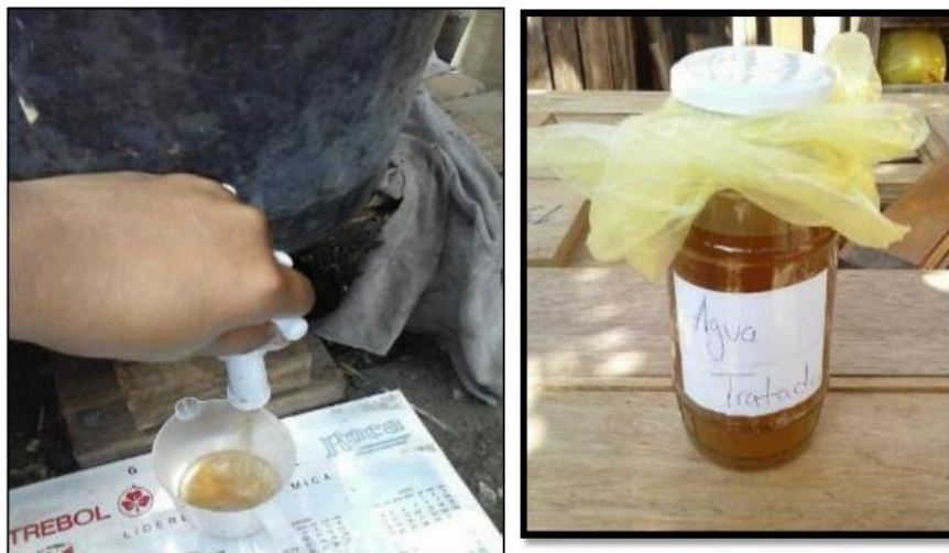
Recoleccion del agua tratada con el biofiltro de lombrices, notandose a simple vista un aceptable color y cambio.
