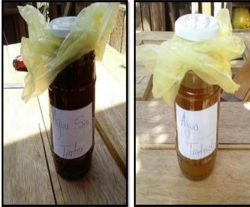
Vista de los frascos con el agua residual antes y despues de ser tratada para su posterior análisis físico – químico y microbiológico
