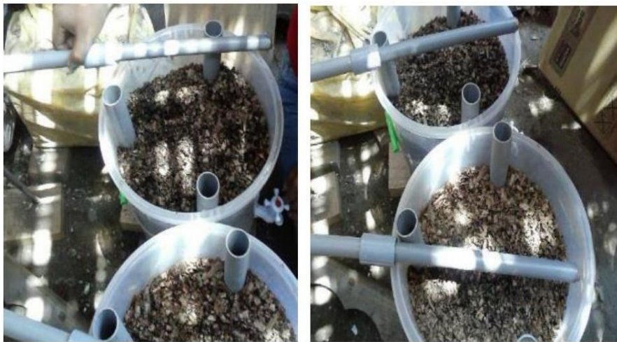
Vista en planta de los biofiltros; notandose los tuvos de ventilacion a los extremos pegados en las paredes, siendo un biofiltro dinamico aeróbico
