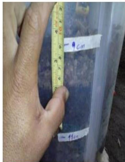
Medida de las capas del biofiltro
