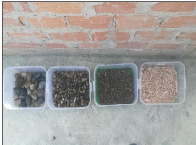
Vista de los materiales que van a conformar las capas del biofiltro
