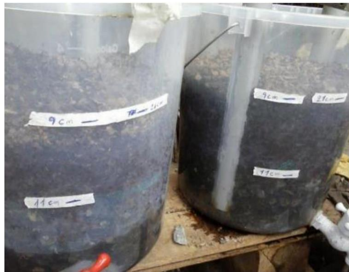
Vista frontal de los biosfiltros de lombrices, notadonse las capas y proceso del tratamiento
