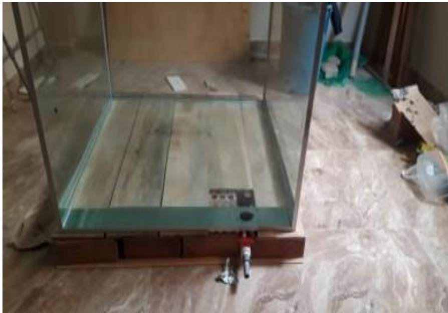
IMAGEN N° 02. Prueba de fuga, para verificar si el biofiltro se encuentra al 100%.
