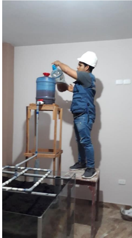
IMAGEN N° 09. Llenado de agua residual al tanque, donde posteriormente será tratada por el biofiltro con lombrices rojas californianas.
