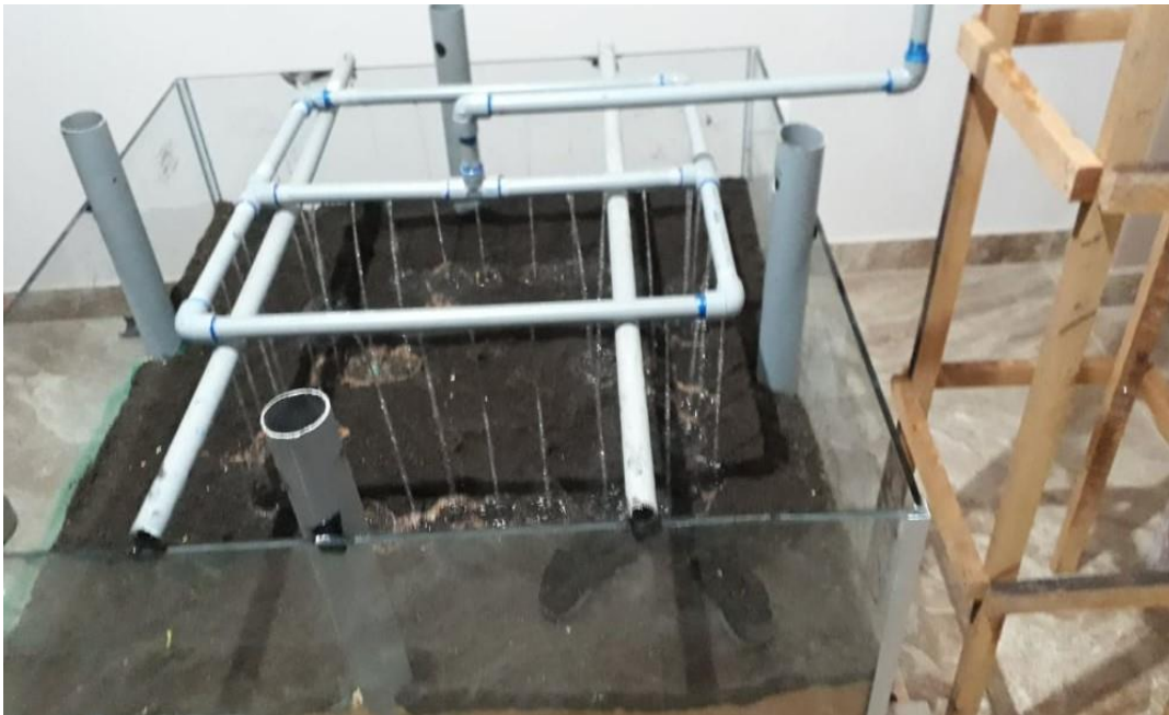
IMAGEN N° 06. Prueba de agua para verificar posibles fugas.
