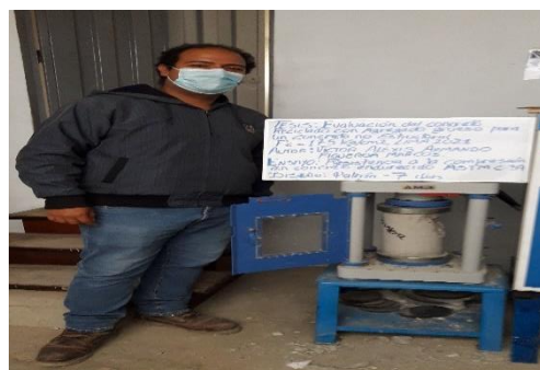
Figura N°06. Ensayo a compresión
