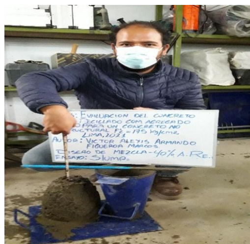
Figura N°26. Ensayo de consistencia
