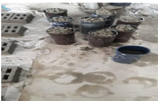
Figura N°05. Vaciado de probetas
