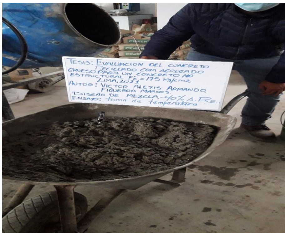
Anexo N°21. Ensayo de temperatura del concreto con 40% con AGR
