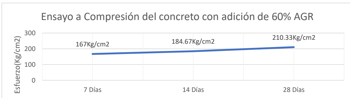
Figura N°14. Curva del Ensayo a Compresión del concreto con adición del 60% de AGR
