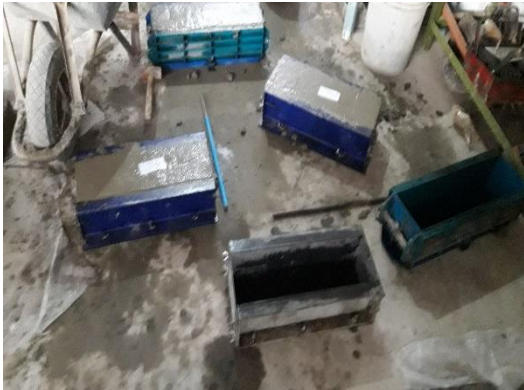
Figura N°17. Vaciado de probetas
