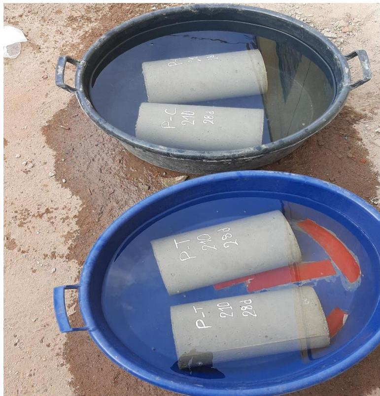
Fotografía 7. Curado de probetas
