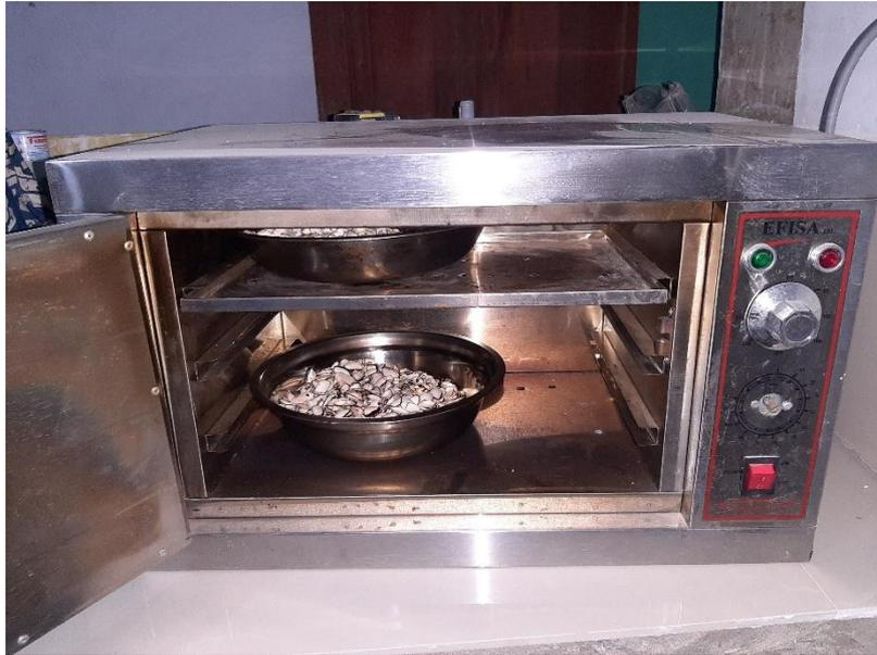
Fotografía 3. Secado de Donax sp. en horno de laboratorio
