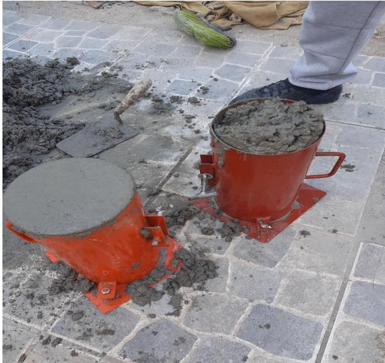
Fotografía 6. Elaboración de probetas
