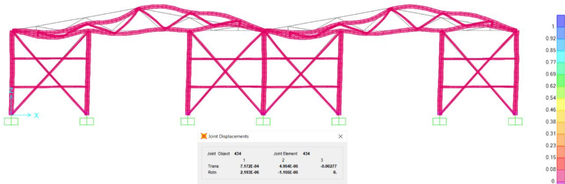
Figura 36. Deformación por viento (CW) - Pórtico 01
