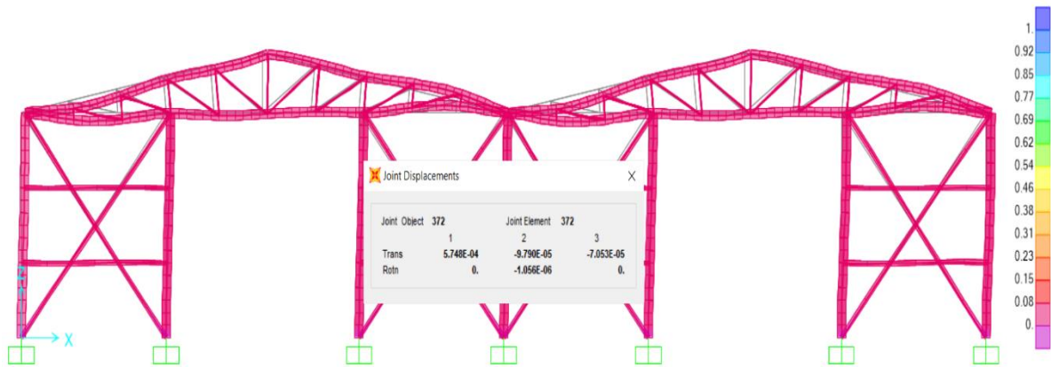
Figura 29. Deformación por viento (CW) - Pórtico 01
