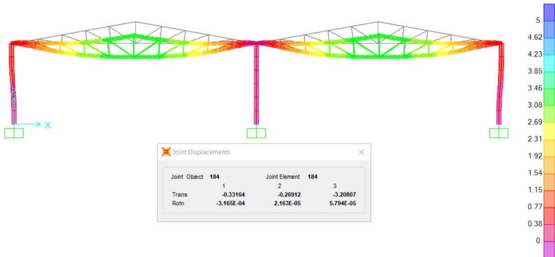
Figura 45. Desplazamiento – Pórtico 1 – Tipo Pratt
