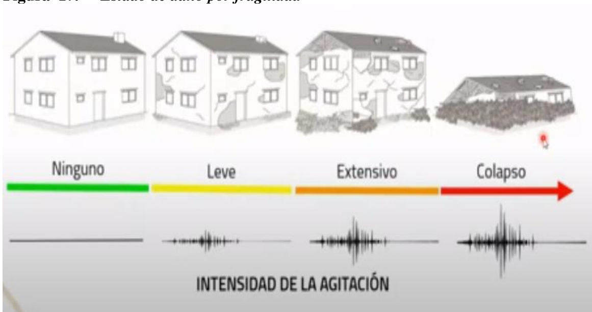
Figura 17. Estado de daño por fragilidad
