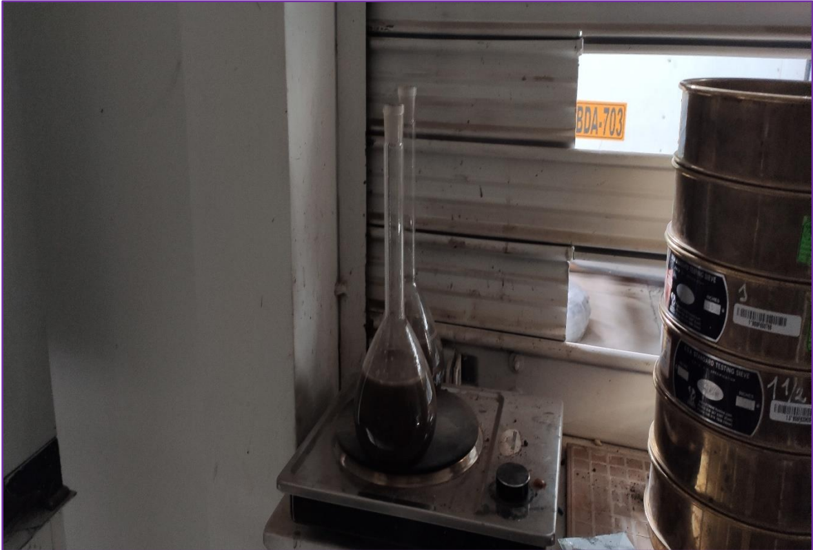
Figura 111.- Pícnómetro es llevado a la balanza para su posterior toma de peso, considerado a 20C°
