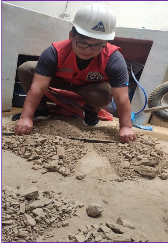
Figura 107.- La muestra extraída, se procede a realizar del cuarteo pertinente.
