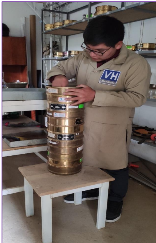
Figura 108.- Análisis granulométrico por tamizado (ASTM D-422)
