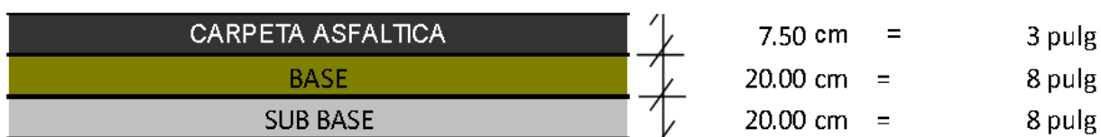
Figura 27. Espesores del Pavimento Flexible
