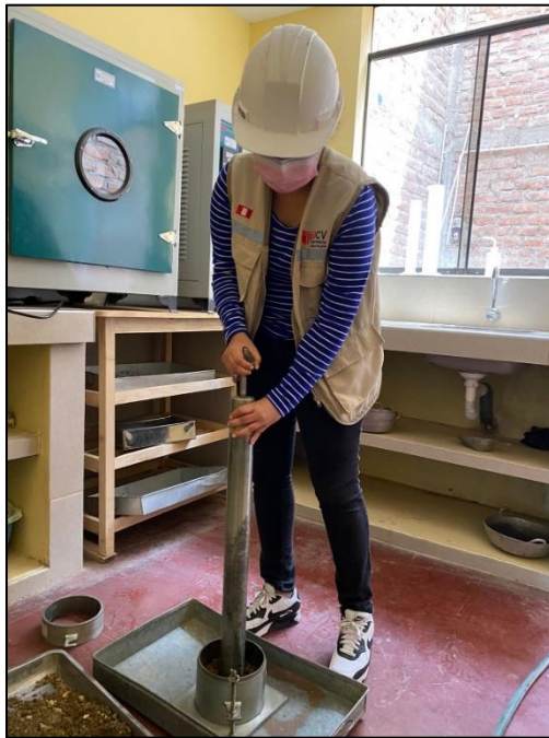
Figura 41. Compactación del Ensayo de Proctor Modificado
