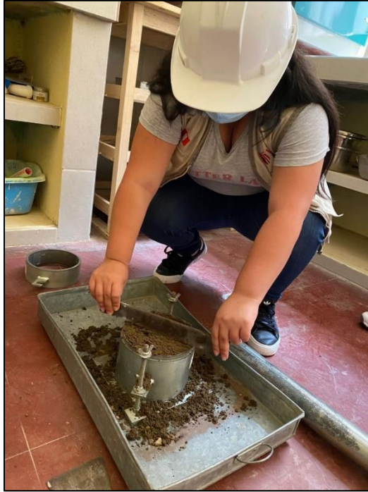
Figura 42. Enrase luego de la compactación del Ensayo de Proctor Modificado
