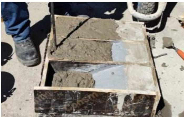
*Figura 6:* se puede observar en la imagen las vigas para ensayo de flexión.
