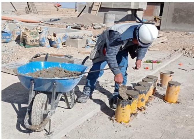
*Figura 5:* se puede observar en la imagen las Briquetas para prueba de compresión.
