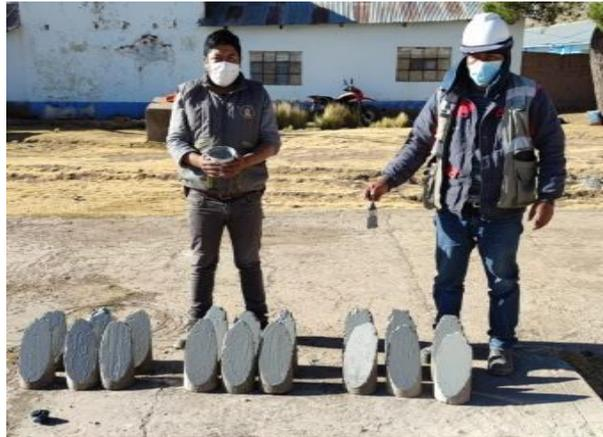
Figura 7: se puede observar en la imagen las Briquetas para ensayo a la tracción indirecta.
