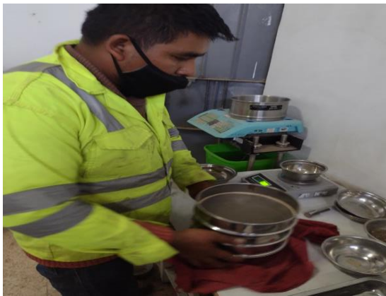
foto 10: En la foto se observa el tamizaje y pesaje de las muestras para determinar la granulometría.
