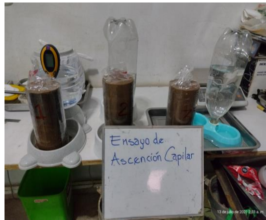
foto 22: En la imagen se observa el ensayo de ascensión capilar en una muestra parcialmente saturada.
