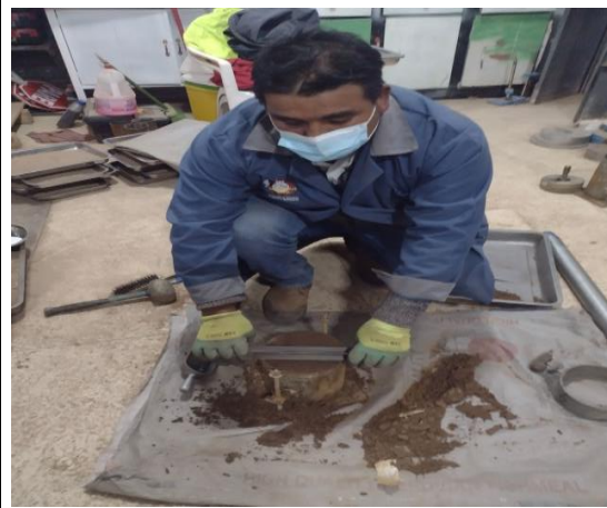
foto 16: Se presenta el apilamiento que se representa parte del ensayo de ascensión capilar.
