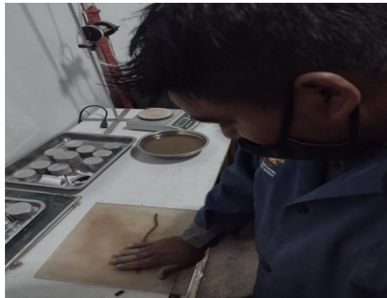
Foto 12: Se observa el ensayo de límite plástico siendo el complemento para determinar el índice de plasticidad.
