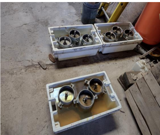
foto 17: En la imagen se observa la muestra es sometido a saturación durante 96 horas denominado ensayo de expansión que se midió a través del dial cada 24 hrs.
