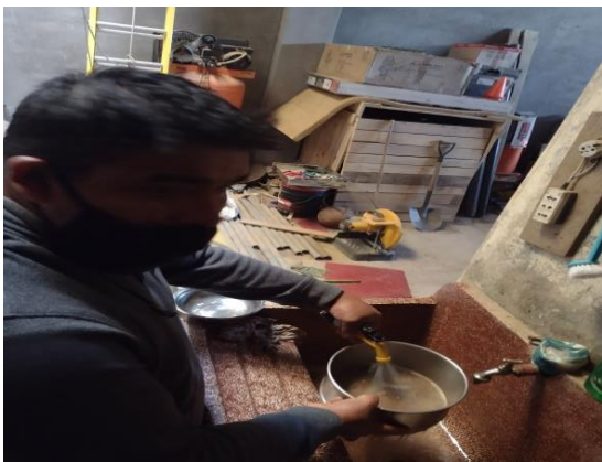
foto 09: En la imagen se muestra el proceso de lavado de la muestra para realizar la granulometría
