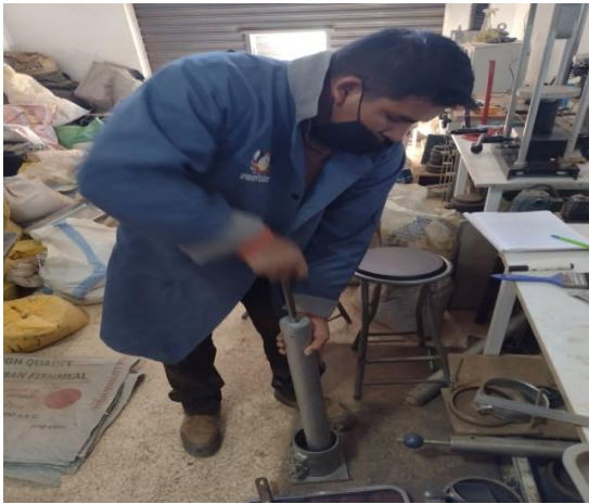
foto 13: Se observa el proceso de compactación para determinar el ensayo de Próctor modificado
