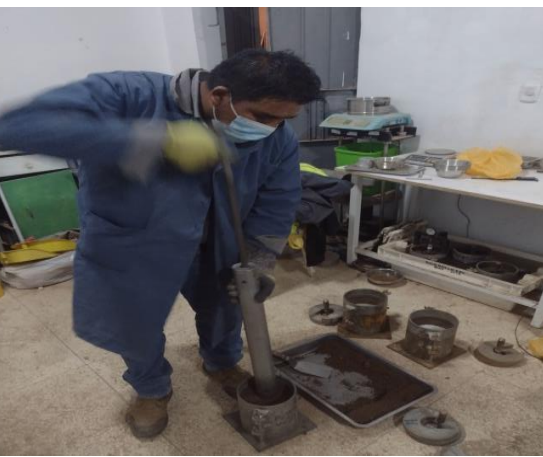
foto 15: A continuación se observa el ensayo de compactación para determinar el ensayo de CBR.
