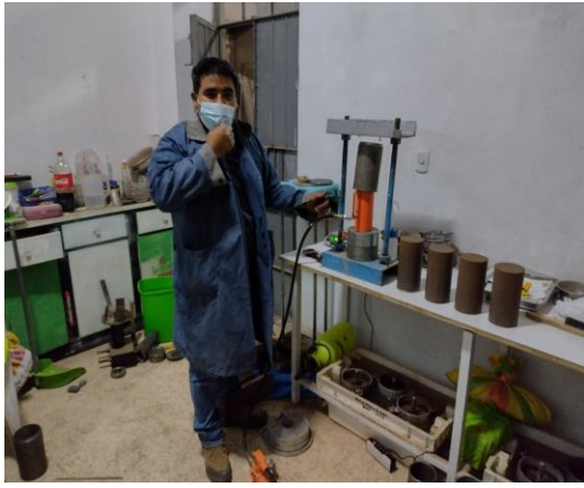
foto 19: En la imagen se observa el remoldeo de las muestras para el ensayo de ascensión capilar
