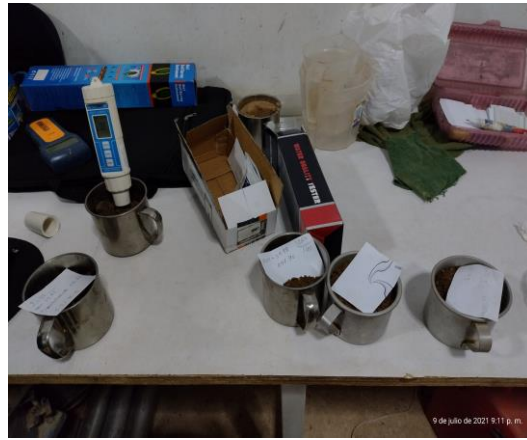
foto 20: En la imagen se observa la calibración del instrumento medidor de humedad.
