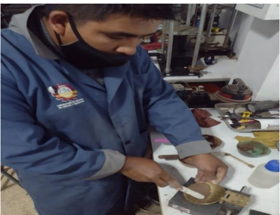
foto 11: En la imagen se presenta en ensayo de límite líquido por medio del instrumento de laboratorio casagrande para determinar el IP.
