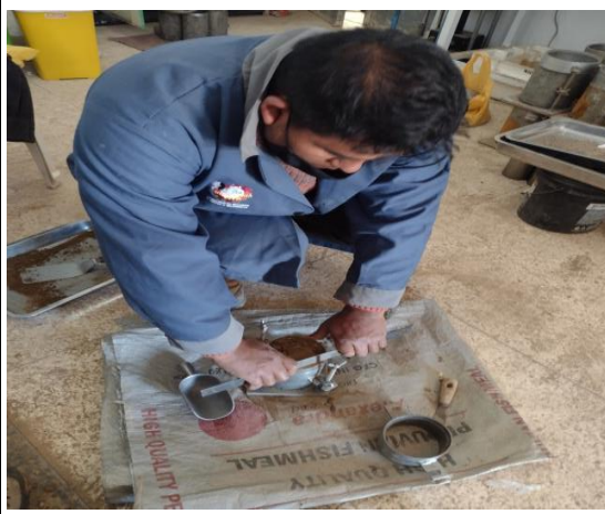
foto 14: en la imagen se observa procesos del ensayo concerniente al ensayo de próctor modificado.
