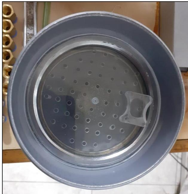
**Figura N° 3:** Diseño interno de las Copas de filtración de bacterias
