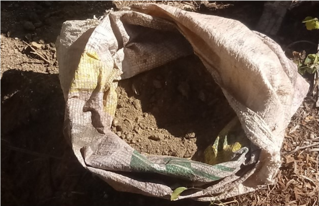
CALICATA DEL TERRENO CON MUESTRA DEL SUELO FRANCO ARCILLOSO.
