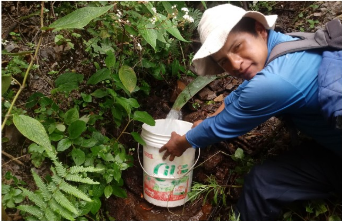
AFORO DE LA FUENTE DE MANANTIAL CON EL MÉTOD VOLUMÉTRICO EN RECIPIENTE DE 20 LT.
