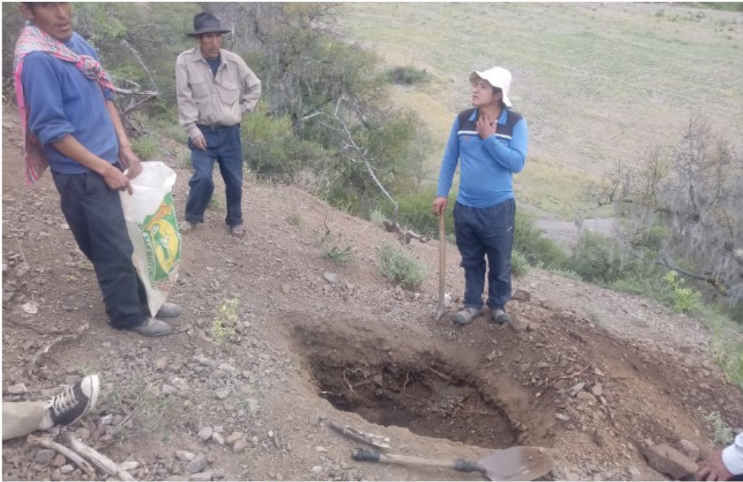
CALICATA O MUESTRA PARA ESTUDIO DE SUELO DE CAPACIDAD PORTANTE PARA RESERVORIO
