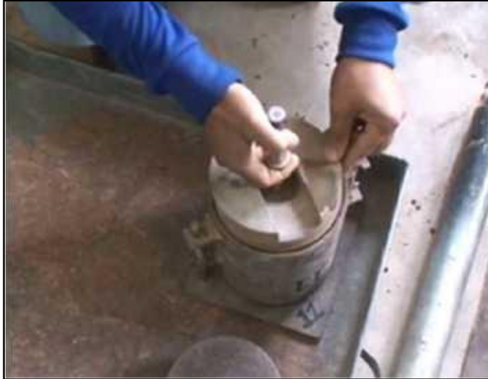
Figura 10: Colocación de los discos espaciadores
