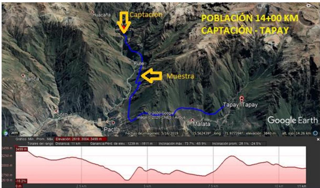
Figura 2. Sketch de proyección de línea de conducción
