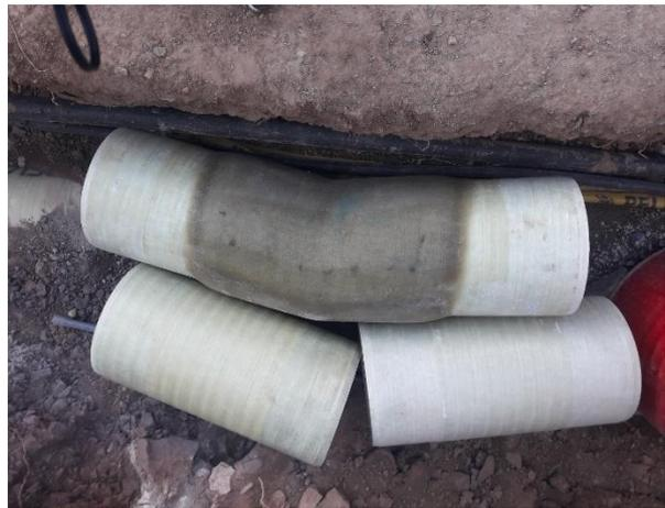
Figura 28. Tubería PRFV
