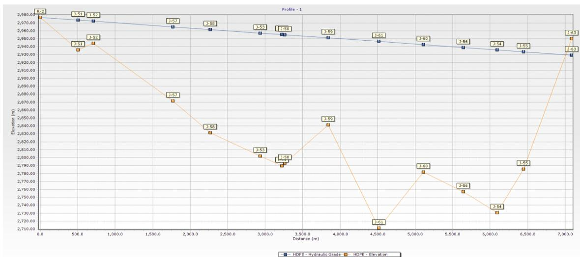
Figura 24. Línea gradiente hidráulica HDPE
