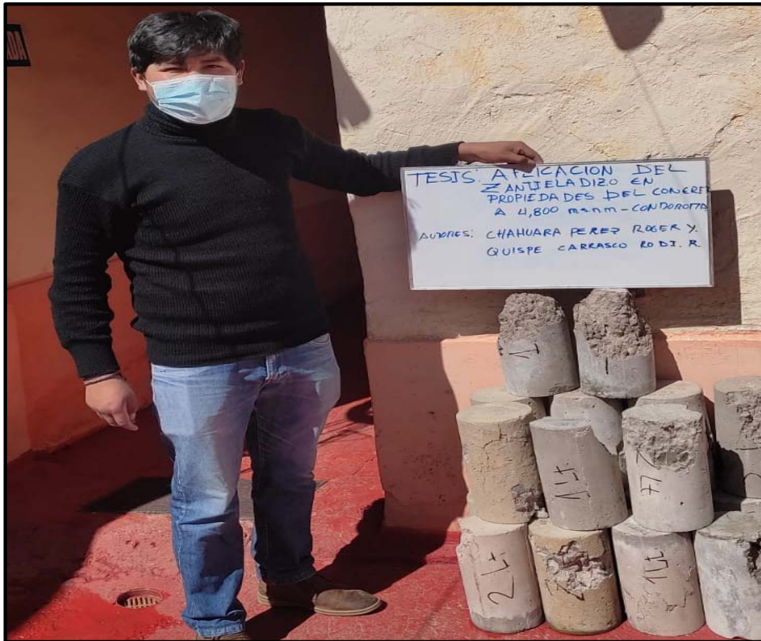
Figura 9. Tipos de falla en los especímenes
