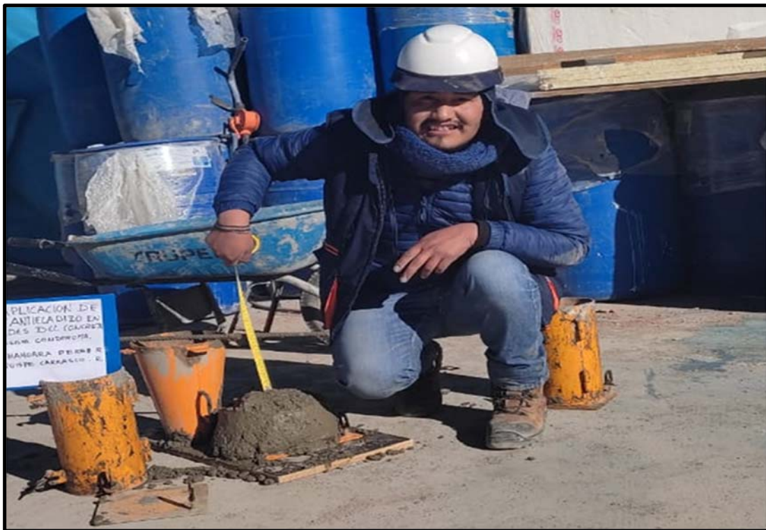
Figura 2. Medición del slump en concreto con aditivo (2 lts) Fuente: elaboración propia.
