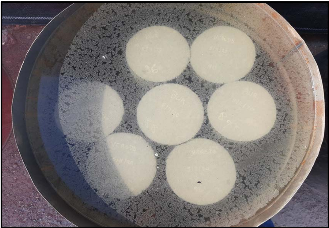
Figura 4. Curado de briquetas Fuente: elaboración propia.
