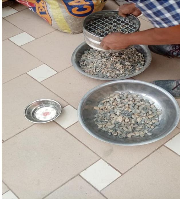
**Figura 5** Ensayo de análisis granulométrico - agregado grueso
