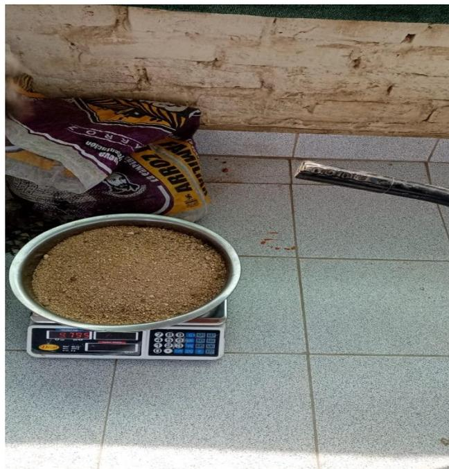
**Figura 2** Peso del agregado fino
