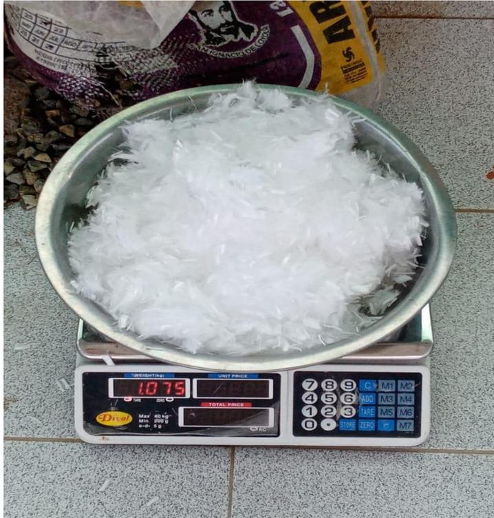
**Figura 3** Peso de la fibra de polipropileno
