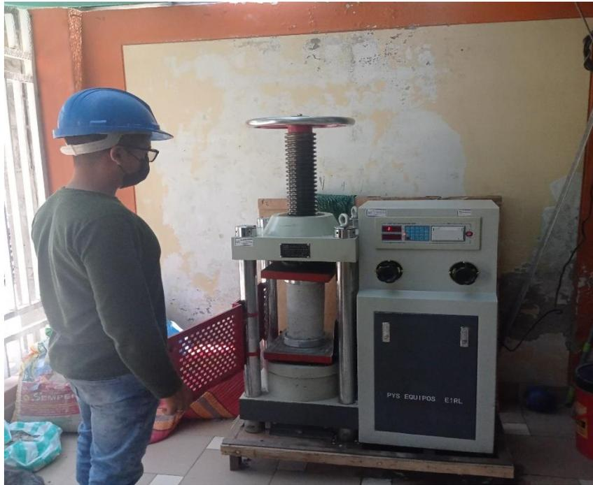
**Figura 11 Ensayo de rotura de probeta**
