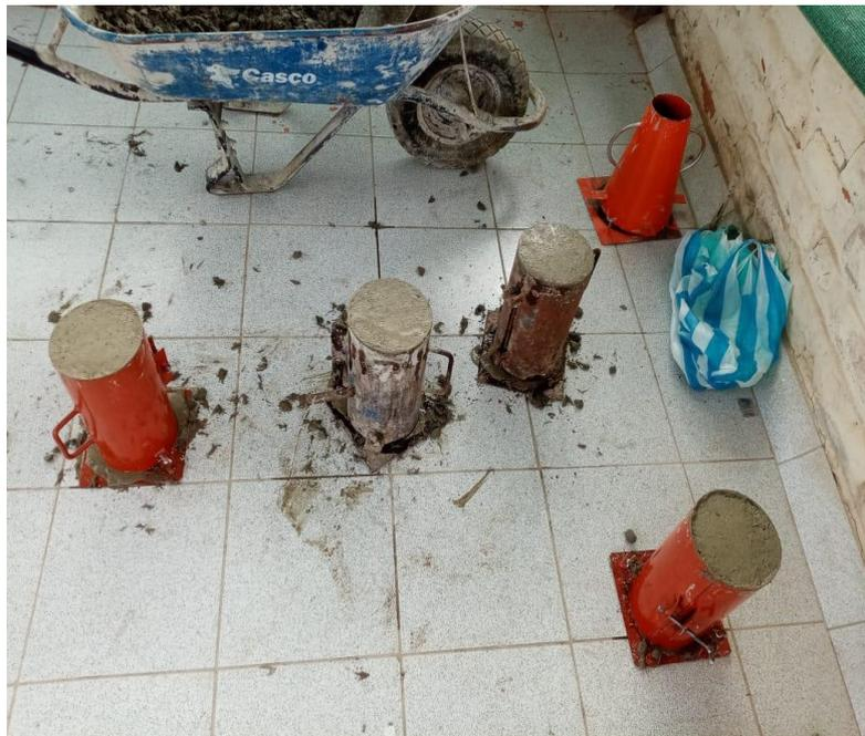
**Figura 8** Proceso de fraguado de las probetas
