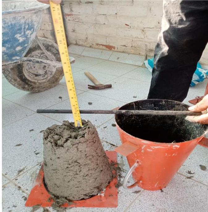
**Figura 7** Ensayo de asentamiento con adición de fibra de polipropileno en la mezcla
