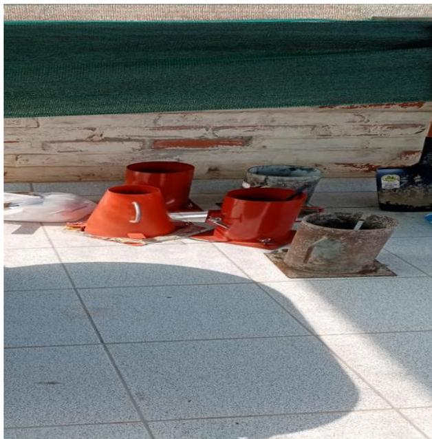
**Figura 6** Moldes de probetas utilizados
