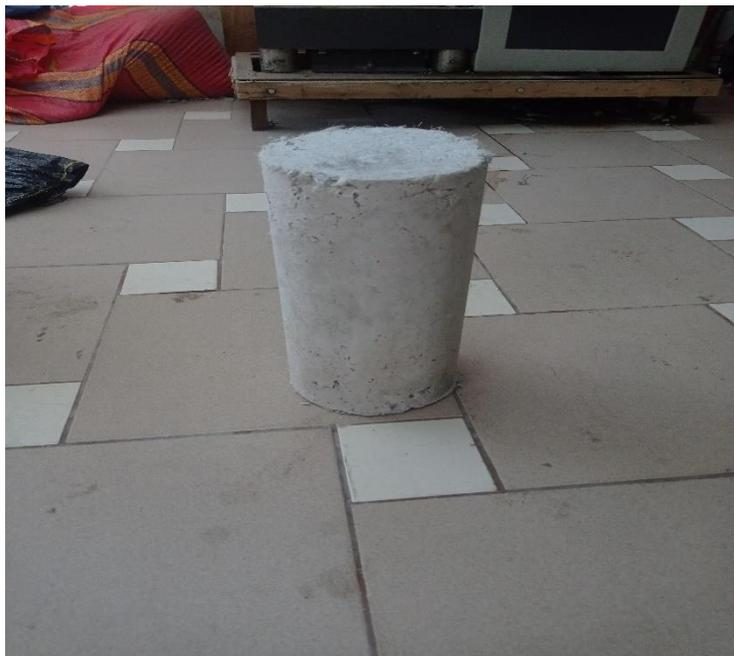
**Figura 10 Probeta de concreto con adición de fibra de polipropileno**
