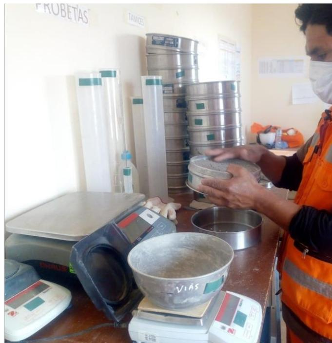
**Figura 4** Ensayo de análisis granulométrico - agregado fino
