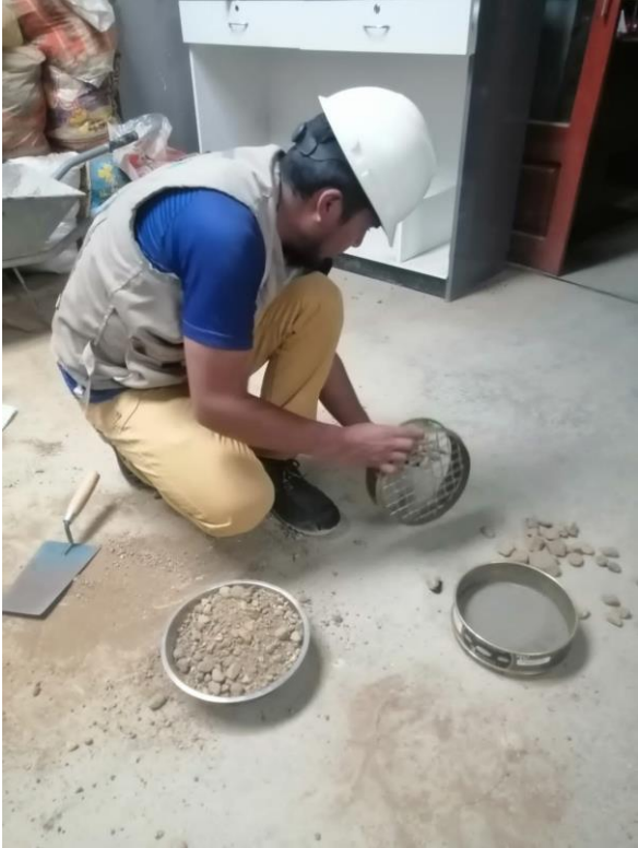
Figura 29: Muestreo para estabilización, tomando muestras representativas
