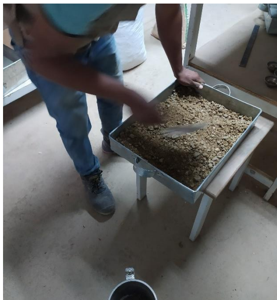
Figura 42: Preparación de la muestra, para la compactación de la otra muestra
