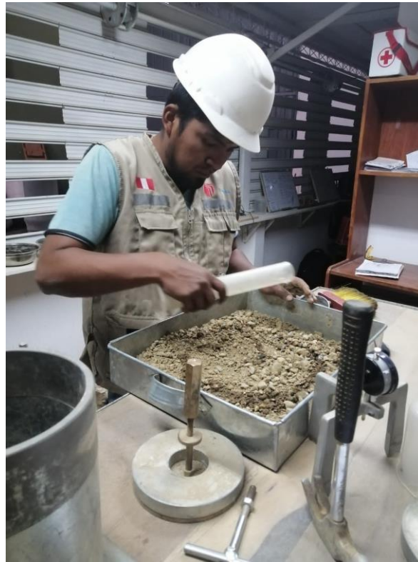
Figura 17: Haciendo el compactado de muestra mezclada en agua, en estado natural
