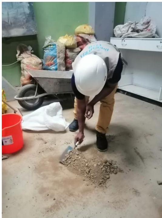
Figura 7: Homogenizando antes del cuarteo
