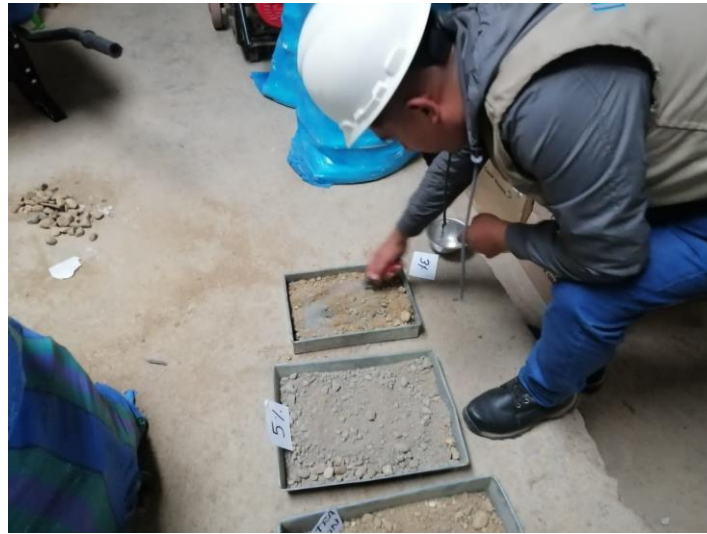
Figura 21: Haciendo el compactado de muestra después de mezclar el cemento y suelo.
