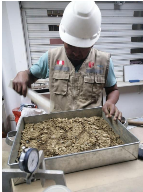
Figura 35: Preparación de la muestra, para el cbr
