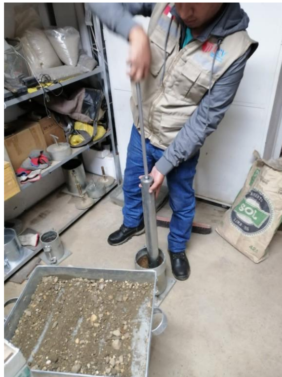
Figura 38: Compactado de la muestra 56 golpes, para el cbr
