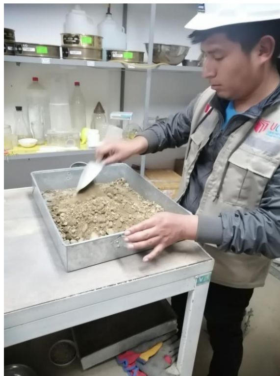
Figura 35: Preparación de la muestra, para el cbr
