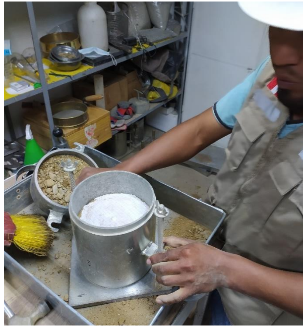
Figura 45: Preparación de la muestra, para la compactación de la otra muestra
