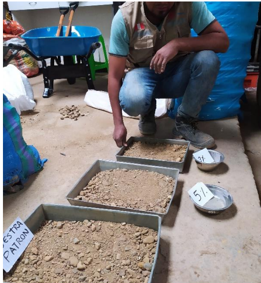
Figura 57: Muestras representativas de 6 kg, con cemento.
