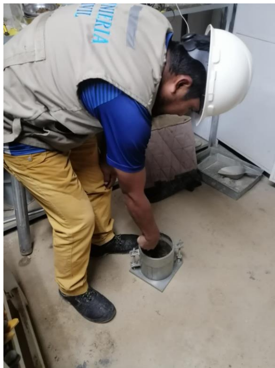
Figura 37: Preparación del molde antes del compactado.
