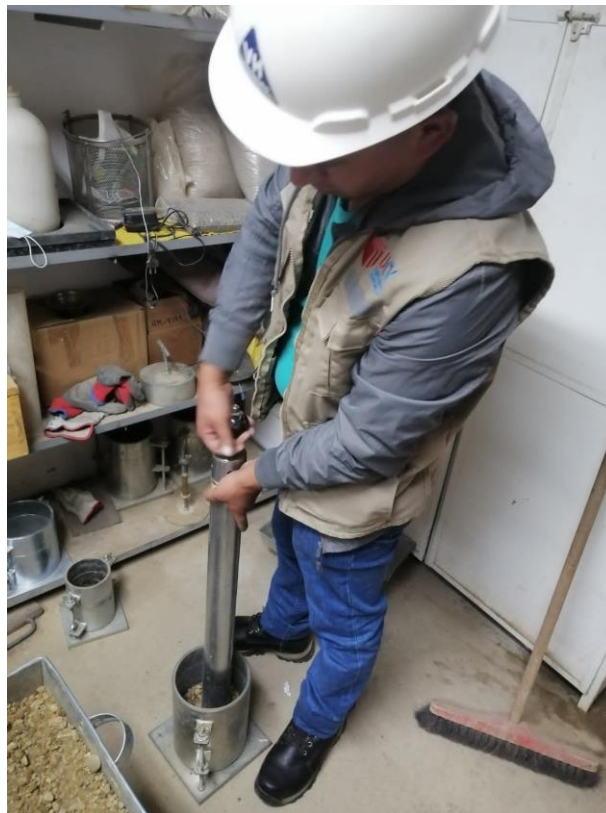
Figura 17: Haciendo el compactado de muestra mezclada en agua, en estado natural
