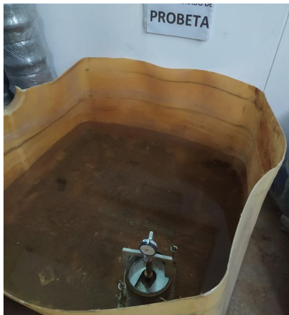
Figura 52: Poniendo la muestra al agua, para ver si expande el suelo.
