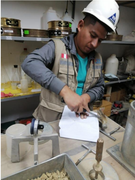
Figura 33: Preparación de la muestra, para el cbr
