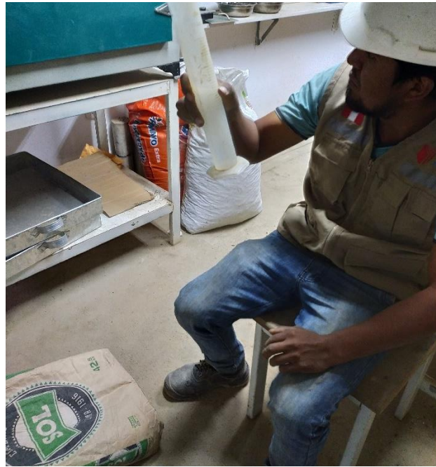
Figura 55: Midiendo el agua, para incorporar a la muestra de 150ml
