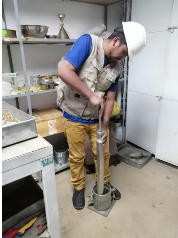
Figura 38: Compactado de la muestra 56 golpes, para el cbr
