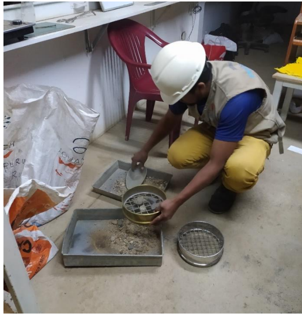
Figura 12: Tamizado para análisis granulométrico
