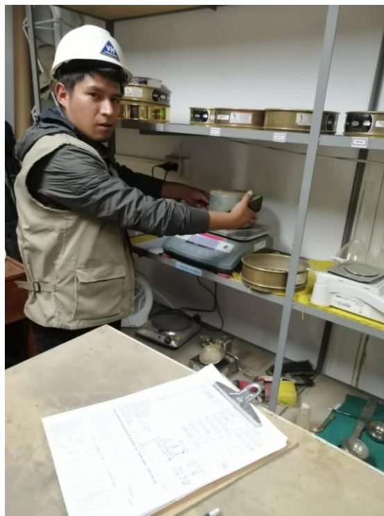
Figura 59: Pesando la muestra de molde compactado
