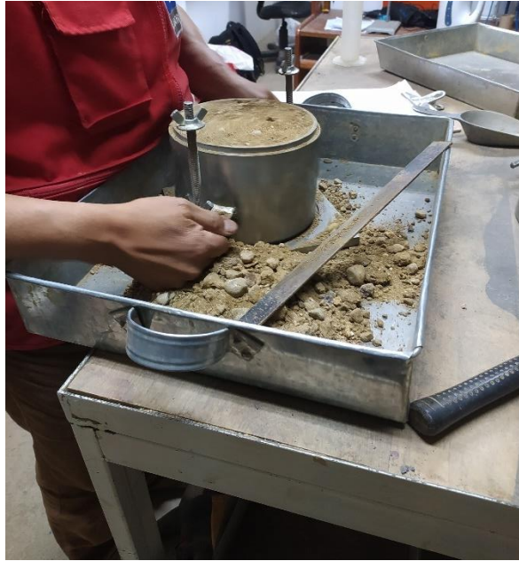
Figura 62: Muestra en el molde para CBR
