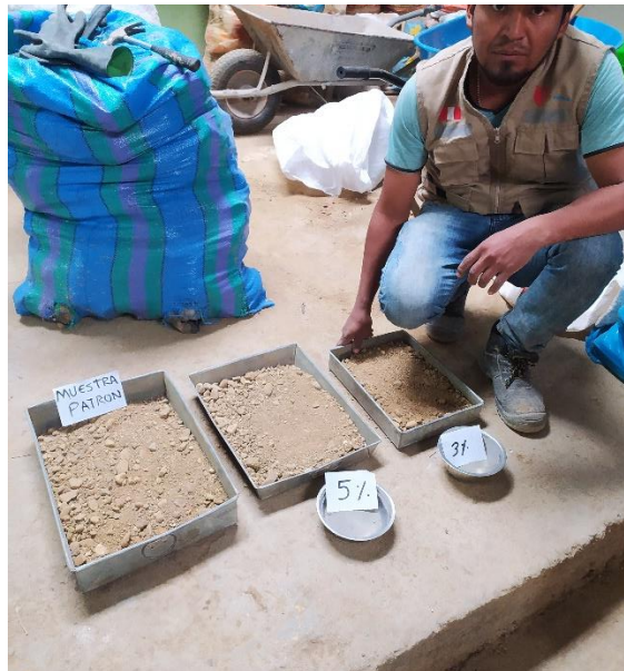
Figura 56: Muestras representativas de 6 kg, con cemento.
