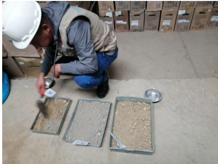
Figura 23: Muestras representativas, de 6 kg, con cemento y suelo estabilizado
