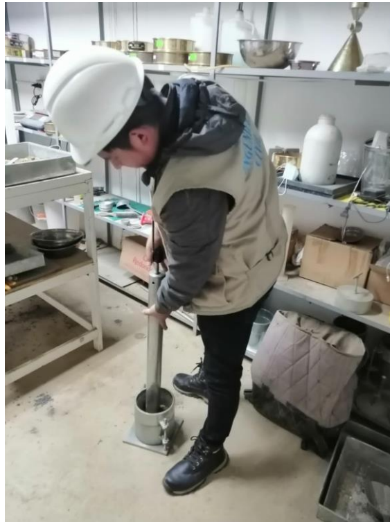
Figura 58: Haciendo la compactación, de suelo cemento
