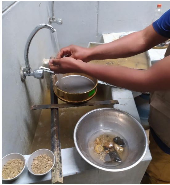
Figura 14: Lavado para análisis granulométrico
