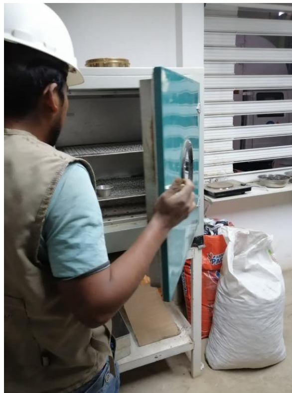
Figura 27: Poniendo la muestra en el horno, después del ensayo
