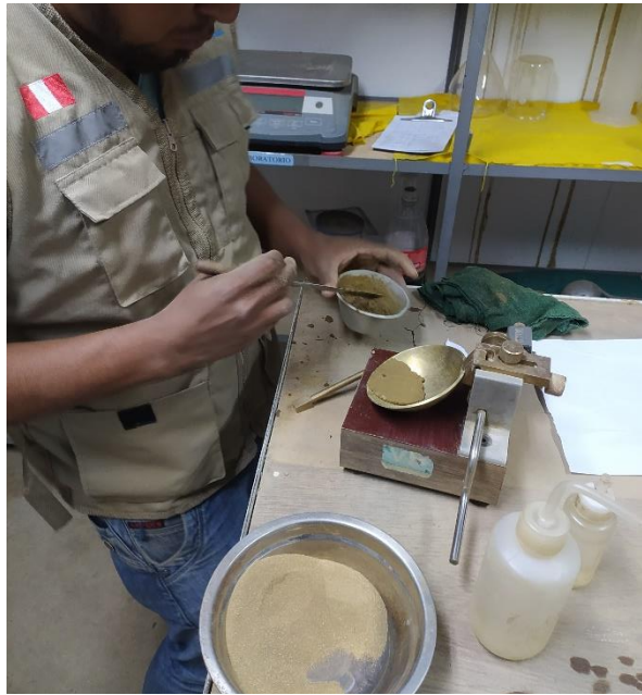
Figura 24: Preparación de muestra para los límites de consistencia
