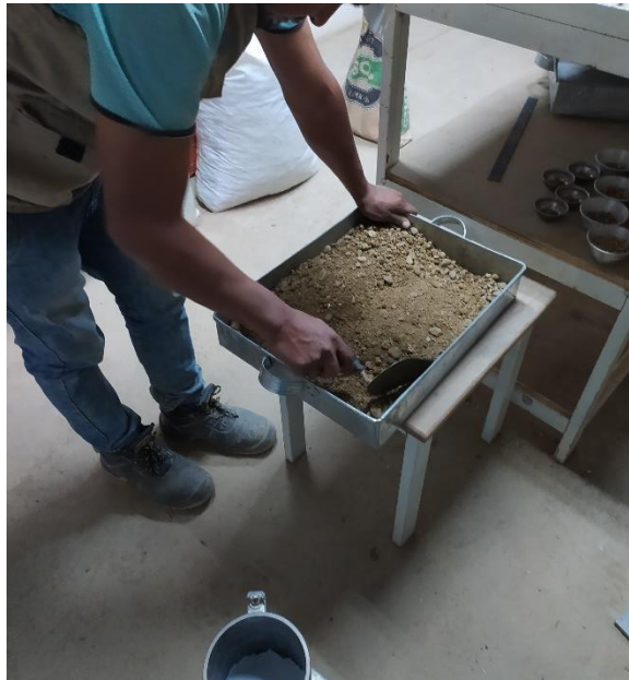
Figura 41: Preparación de la muestra, para la compactación de la otra muestra
