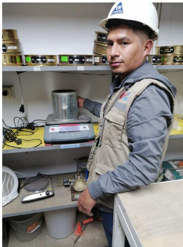
Figura 19: Pesando la muestra compactada
