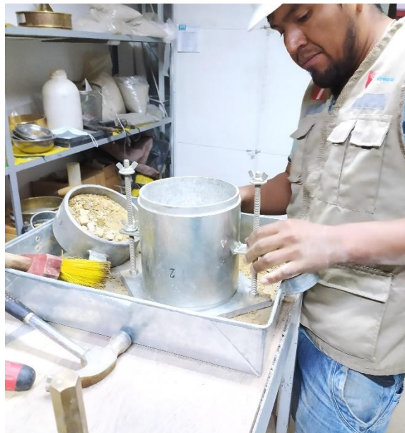
Figura 44: Desarmando el molde, para tomar una muestra representativa para hacer el peso
