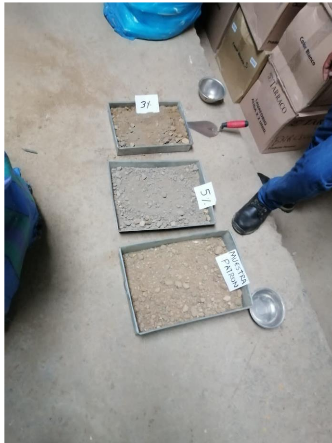
Figura 23: Muestras representativas, de 6 kg, con cemento y suelo estabilizado
