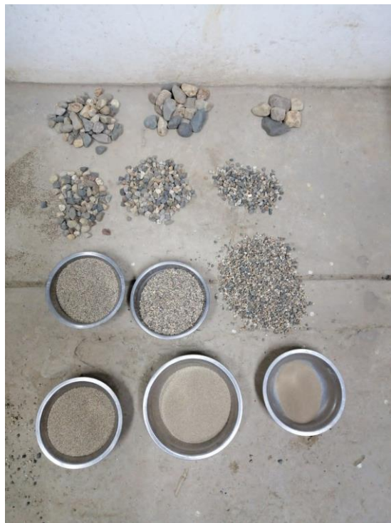
Figura 13: Tamizado para análisis granulométrico
