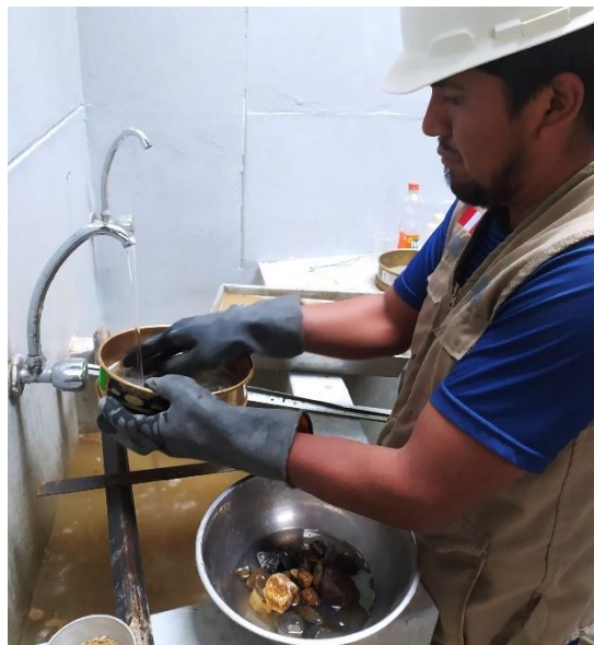
Figura 15: Tamizado para análisis granulométrico
