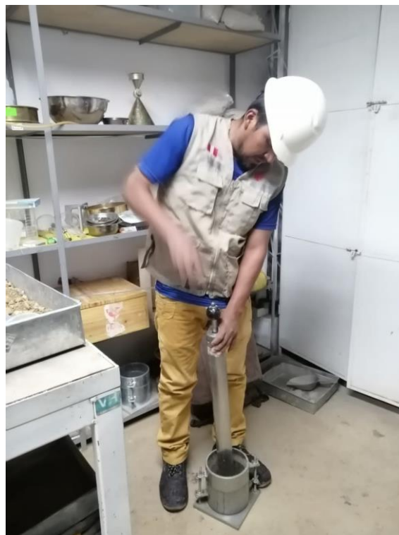
Figura 21: Haciendo el compactado de muestra después de mezclar el cemento y suelo.
