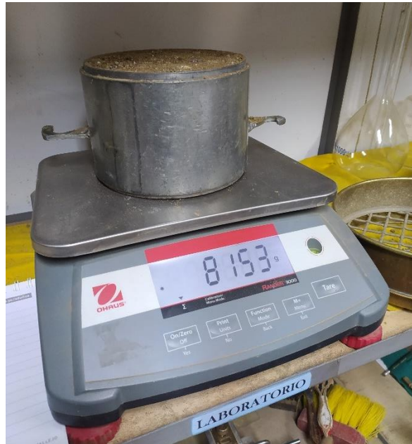
Figura 64: Pesando la muestra y el molde
