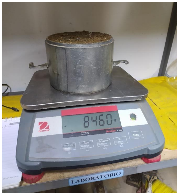
Figura 63: Pesando la muestra y el molde
