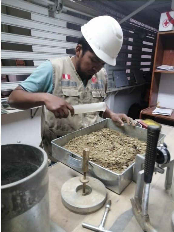
Figura 33: Preparación de la muestra, para el cbr
