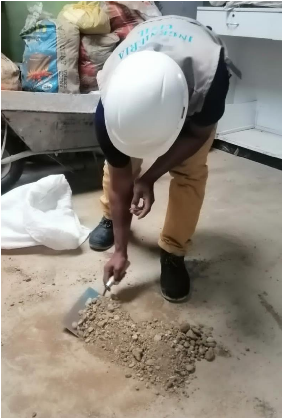
Figura 29: Muestreo para estabilización, tomando muestras representativas
